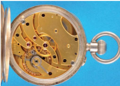
**414 Große Silber-Beobachtungsuhr mit Chronometer-Hemmung, August Ericsson, Petersburg, im Original-Verkaufs-Etui, glattes Gehäuse, Emailzifferblatt mit römischen Zahlen, kleiner Sekunde, gebläute Zeiger, vergoldetes Brückenwerk mit Chronometerhemmung über Feder, intakt (3929-08), D = 60 mm 3400,-**
