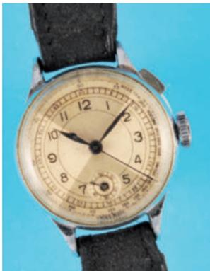
667 **Damen-Armbanduhr Monopusher mit Schaltrad-Chronograph über 1 Drücker, eines der kleinsten Schaltrad-Chronographenwerke**, verchromtes Gehäuse mit Druckboden, versilbertes Zifferblatt mit arabischen Zahlen, arabische Minuterie und Tachymeterskala, kleine Sekunde, gebläute Zeiger, weißes Werk mit Ankergang, Schraubennurh und Flachspirale, 1940er-Jahre, intakt, Gebrauchsspuren (6455), D = 26 mm 600,-
