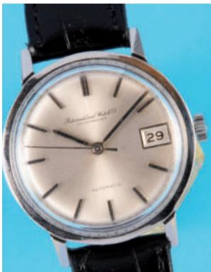
670 **IWC, International Watch Co., Automatic Armbanduhr mit Zentralsekunde und Datum**, cal. 8541, gleiches Kaliber wie in Ingenieur, um 1968, Gehäuse mit Stahlschraubboden, versilbertes Zifferblatt mit aufgesetzten Stundenindexen, Zentralsekunde, Datumsfenster bei 3, weißes Werk mit Rotoraufzug, Ankergang mit Ringunruh, Breguet-Spirale und Stoßsicherung, intakt (6616), D = 34 mm 850,-
