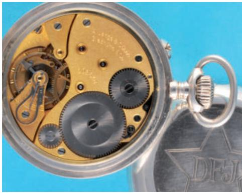
403 **A.Lange & Söhne, Glashütte in Sachsen, Beobachtungsuhr mit Gangreserve**, Nickelgehäuse mit Druckboden, graviert DFJ im Stern, fertiggestellt bei A.Lange & Söhne, versilbertes Zifferblatt mit arabischen Zahlen, kleine Sekunde bei 3 und 35-Stunden-Gangreserve bei 9, gebläute Zeiger, vergoldetes Werk mit Ankergang, große Kompensationsunruh mit Breguet-Spirale und Schwanenhals-Feinregulierung, um 1940, intakt (6040), D = 59 mm 3600,-
