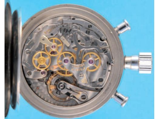
408 **Große Longines 30-Sekunden-Stoppuhr mit Schleppzeiger (Rattrapant) und 30-Minuten-Zähler**, gebläute Zeiger, Referenz 4357.4, cal. LXW, Edelstahlgehäuse, versilbertes Zifferblatt mit 30-Sekunden-Skala mit 1/10-Sekundeneinteilung und roter Skala von 31-60, im oberen Teil 30-Minuten-Zähler, gebläute Zeiger, weißes Werk mit Ankergang, Schraubenunruh, Breguet-Spirale und Schwanenhals-Feinregulierung, 21 Jewels, in 3 Lagen justiert, 1950er-Jahre, Intakt (6513), D = 66 mm 1100,-
