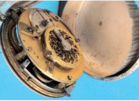
345 **Deutsche Spindelstaschenuhr mit Silber-Staubschutz**, auf Zifferblatt und Werk sign. **Fahrländer in Gengebach**, glattes Silbergehäuse mit Außenscharnier, Emailzifferblatt mit römischen Zahlen, gebläute Zeiger (ersetzt), vergoldetes Werk mit Spindelgang über Schnecke und Kette, reich verzierter silberner Staubschutz, filigran ausgeschnittene Spindelbrücke, eckige Pfeiler, um 1800, intakt (2858), D = 49 mm 260,-
