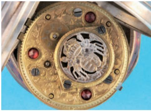
342 **Alpeinländische Spindelstaschenuhr mit ungarischem Königs-Wappen als Spindelbrücke und 3 roten Schmucksteinen**, Übergehäuse lackiert im Schildpattdesign, Emailzifferblatt mit römischen Zahlen, vergoldete Zeiger, reich verziertes, vergoldetes Werk mit Spindelgang über Schnecke und Kette, um 1800, intakt (6436), D = 61 mm 1200,-
