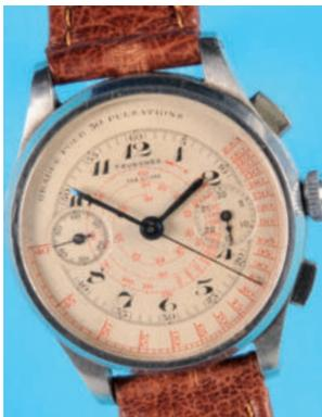
458 **Tavannes Armbanduhr mit Chronograph mit 30-Minuten-Zähler, diverse Chronographenskalen und Pulsationsskala**, Gehäuse mit Stahl-Druckboden, cremefarbenes Zifferblatt mit arabischen Zahlen, rote Chronographenskala, arabische Minuterie, kleine Sekunde bei „9“, 30-Minuten-Zähler bei „3“, gebläute Zeiger, Werk mit Ankergang, Schraubenunruh und Breguet-Spirale, Schaltrad-Chronograph, 1950er-Jahre, intakt, Reinigung empfohlen (3793), D = 36 mm 900,-
