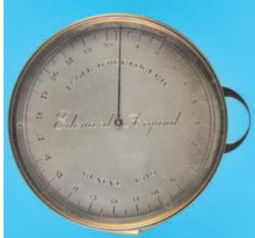
765 **Antiker Schul-Mikrometer von Edouard Argand, Ecole d'Horlogerie Genève 1910, rundes Messinggehäuse mit seitlichem Schieber, versilbertes Zifferblatt mit Skala von 1-23 (2635), D=67 mm 180,-**
