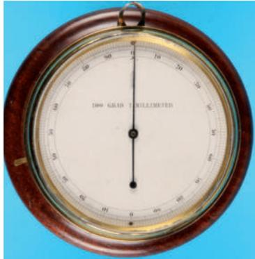
764 **Antiker Mikrometer im Messinggehäuse auf rundem Holzsockel, Nr. 2867, auf Sockel und Messinggehäuse identisch, Pappzifferblatt, 100 Grad - 1 Millimeter (2634), D = 60 mm, Sockel = 72 mm 250,-**
