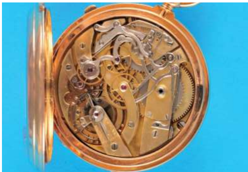
271 Feine Goldtaschenuhr mit Sprungdeckel und Chronograph, Patek Philippe & Cie. Genève , glattes 18 ct.-3-Deckel-Goldgehäuse, Emailzifferblatt mit römischen Zahlen, arabischer Minuterie und Chronographenskala mit 1/5-Sekundenteilung, vertiefte kleine Sekunde, gebläute Zeiger, zentraler Chronographenzeiger, vergoldetes Brückenwerk mit Ankergang, Moustache-Anker, Kompensationsunruh und Breguet-Spirale, um 1880, intakt (8952) D = 52 mm, ca. 107 g. 9500,-
