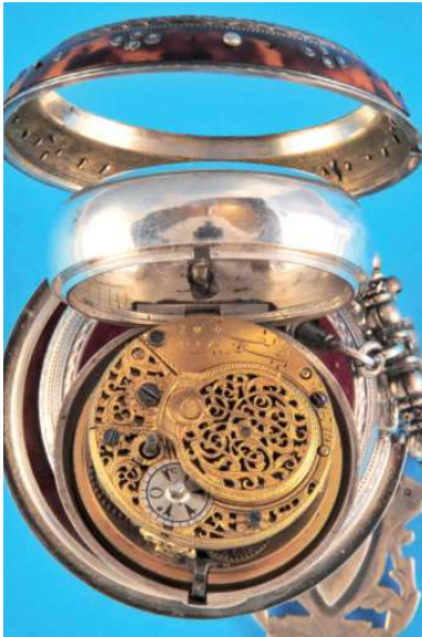
563 Silberne Spindel Taschenuhr für den türkischen Markt mit 2 Übergehäuse und silbernem Chatelaine , auf Zifferblatt und Werk sign. Ralph Gout London (Lit. Baillie S.128), ca.1770-1836, glatte Gehäuse und Übergehäuse, mit Schildpatt und Silbernägeln verziertes 2. Übergehäuse mit Außenscharnier, Emailzifferblatt (Risse), gebläute Poker- und Beetle-Zeiger, feuervergoldetes Werk mit Fantasiepfeilern, filigraner Spindelkloben, intakt (756), D = 62 mm 1400,-
