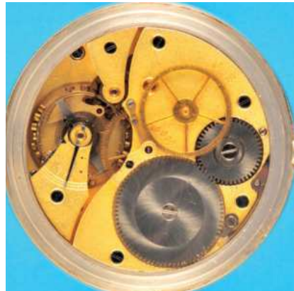
602 Seltene, große Silber-Beobachtungs-Taschenuhr mit Zentralsekunde , GUB Glashütter Uhrenbetriebe, Werk- und Gehäusenummer 218007, Grundplatine 217979, glattes Gehäuse, schwarzes Zifferblatt mit arabischen Leuchtzahlen, Leuchtzeiger, Zentralsekunde, vergoldetes Platinenwerk mit Ankergang, Stahlanker und Stahlankerrad, Kompensationsunruh mit Breguet-Spirale und Schwanenhals-Feinregulierung, intakt (8510), D = 58 mm 2100,-
