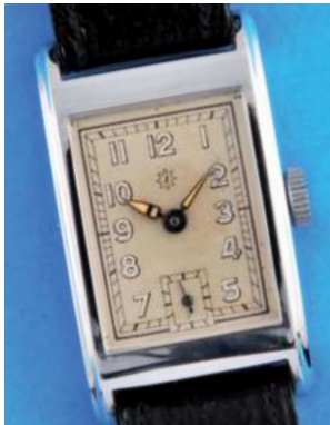
171 Junghans, cal. 957, rechteckiges Gehäuse, versilbertes Zifferblatt mit arabischen Leuchtzahlen, Leuchtzeiger, kleine Sekunde, weißes Formwerk mit Ankergang, Schraubenunruh und Flachspirale, 30er-Jahre, intakt (7628), M = 31 x 22 mm 120,-
