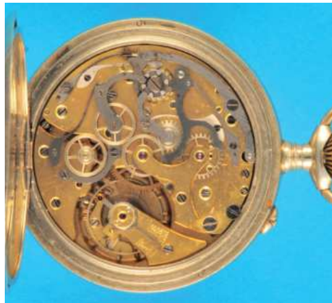
198 Metall-Taschenuhr mit Chronograph und 30-Minuten-Zähler , glattes Neusilbergehäuse, Emailzifferblatt mit arabischen Zahlen und mehrfarbigen Chronographenskalen, kleine Sekunde bei „6“, 30-Minuten-Zähler bei „12“, gebläute Zeiger, vergoldetes Werk mit Ankergang, Schraubenunruh und Breguet-Spirale, um 1900, intakt (8089), D = 51 mm 230,-
