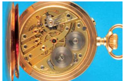
268 Goldtaschenuhr IWC "Qualität Extra" , guillochiertes 14-ct.-Gehäuse mit Goldcuvette, feines Emailzifferblatt mit arabischen Zahlen, kleine Sekunde, Goldzeiger, vergoldetes Brückenwerk cal. 65 mit Ankergang, Nr. 181423, mit 4 geschraubten Chatons, Kompensationsunruh, Breguet-Spirale und Schwanenhals-Feinregulierung, um 1898, intakt (8583), D = 52 mm, ca. 98 g. 2800,-
