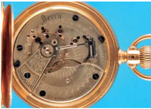
258 Hampden Watch Co., „Perry“, Springfield, Massachusetts, USA , große, schwere Gold-Taschenuhr mit Sprungdeckel, guillochiertes 14-ct.-3-Deckel-Goldgehäuse mit geripptem Mittelteil, 3-teiliges Emailzifferblatt (3 kleine Haarrisse) mit arabischen Zahlen und roter arabischer Minuterie, feine gebläute Zeiger, fein ziselierendes weißes Vollplatinenwerk mit Ankergang, cal. Perry , mit 5 geschraubten Chatons, Feinregulierung mittels langem Räderzeiger mit Schraube und Skala auf der Werkplatine, um 1880, intakt (9299), D = 54 mm, Goldgewicht ca. 77 g., gesamt ca. 144 g. 2000,-
