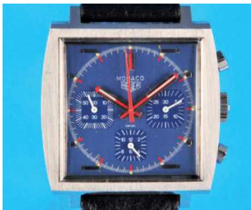
585 Heuer „Monaco“ Stahlarmbanduhr-Chronograph mit 30-Minuten- und 12-Stunden-Zähler , Referenz 73633, viereckiges, 2-teiliges Patentgehäuse mit Unterlegglas und Reilskrone, Edelstahl, blaues Zifferblatt mit Stundenindex und Leuchtpunkten, Leuchtzeiger, kleine Sekunde bei „9“, 30-Minuten-Zähler bei „3“, 12-Stunden-Zähler bei „6“, Schweizer Ankerwerk, cal. Valjoux 7736, Ringunruh mit Flachspirale, Incabloc-Stoßsicherung, um 1970, intakt (8532), M = 40 x 38 mm 5900,-
