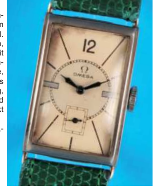
382 Omega , rechteckige Armband-uhren mit zusätzlichem Staubschutzdeckel, cal. T17, um 1935, Stahlboden, versilbertes Zifferblatt mit arabischer 12 und Stundenindexen, kleine Sekunde, gebläute Zeiger, weißes Formwerk mit Ankergang, Kompensationsunruh und Breguet-Spirale, intakt (8991/1), M = 33 x 22 mm 750,-
