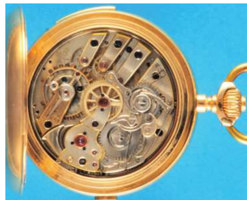
472 Goldsavonnette mit 1/4-Repetition und Chronograph , glattes 14-ct.-3-Deckel-Goldgehäuse, auf Cuvette bez. Friedheim, Emailzifferblatt mit römischen Zahlen und arabischer Minuterie, Chronographenskala mit 1/5-Sekunden-Einteilung, kleine Sekunde, vergoldete Zeiger, Chronograph über Drücker am Gehäuserand, Repetition auf zwei Tonfedern über Schieber, weißes Werk mit Ankergang, Kompensationsunruh und Breguet-Spirale, 2 Lagersteine in verschrauben Chatons, 32 Rubis, um 1900, intakt (8475), D = 53 mm, ca. 116 g. 1900,-
