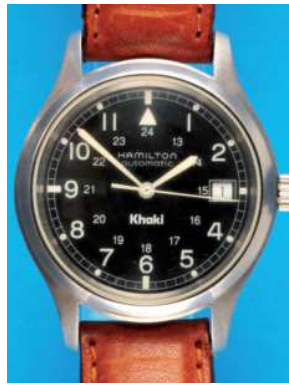
611 Hamilton „Khaki“-Automatic-Stahl-Armbanduhr mit Zentralsekunde, Datum und Original-Etui , Referenz 9721, cal. ETA 2824-2, 2010er-Jahre, Gehäuse mit Edelstahl-Schraubboden, Original-Lederband, schwarzes Zifferblatt mit arabischen Leuchtzahlen und Leuchtpunkten in der Minuterie, Leuchtzeiger, Zentralsekunde, Skala von 13-24, Datumsfenster bei „3“, Ankerwerk mit Rotoraufzug, 25 Steine, Ringunruh, Flachspirale und Stoßsicherung, intakt (8879), D = 36 mm 330,-
