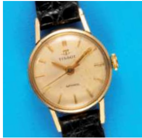
505 Tissot Automatic Damen-Gold-Armbanduhren mit Zentralsekunde, 14 ct.-Goldgehäuse mit Druckboden, versilbertes Zifferblatt mit aufgesetzten vergoldeten Stundenindexen, vergoldete Zeiger, Zentralsekunde, weißes Werk, cal. 717 (ETA 2365) mit Ankergang und Rotoraufzug, Schraubenunruh, Flachspirale und Stoßsicherung, 21 Jewels, 1960er-Jahre, intakt (8264), D = 20 mm 280,-
