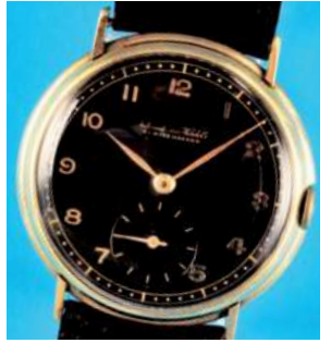
457 IWC Goldarmbanduhr mit seltenem Kaliber 62 , 1939, 14-ct.-Goldgehäuse mit Druckboden, schwarzes Zifferblatt mit vergoldeten arabischen Zahlen, vergoldete Zeiger, kleine Sekunde, weißes Werk mit Genfer Streifen, Ankergang mit Kompensationsunruh und Breguet-Spirale, intakt (9242), D = 33 mm 1400,-
