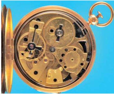
426 Goldtaschenuhr mit Viertel-Repetition , guillochiertes 14-ct.-Gehäuse, Emailzifferblatt mit römischen Zahlen, vergoldete Zeiger, vergoldetes Werk mit freistehendem Federhaus, Zylinderwerk mit Schlüsselaufzug, Schlagabruf auf 2 Federn über Pendant, intakt (5005), D = 55 mm 1900,-
