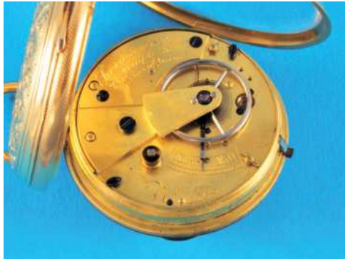
465 Swinden & Sons, Birmingham , reich gravierte 18-ct.-Goldtaschenuhr, (Lit. Loomes S. 227) 1858-80, im Gehäuse Widmung von 1870, Emailzifferblatt mit römischen Zahlen, kleine Sekunde, vergoldetes Werk mit Staubschutzring und Spitzzahnankergang über Schnecke und Kette, Ringunruh und Flachspirale, intakt (8728), D = 40 mm, ca. 59 g. 1100,-
