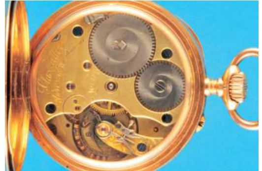
285 Goldtaschenuhr, Uhrenfabrik Union Glashütte bei Dresden, guillochiertes 14-ct.-2-Deckel-Roségold-Gehäuse, Emailzifferblatt mit arabischen Zahlen, kaum sichtbare Haarrisse, rote Minuterie, kleine Sekunde, vergoldete Zeiger, vergoldetes 3/4-Platinenwerk unter Glasschutz, mit Goldanker und Goldankerrad, Kompensationsunruh mit Breguet-Spirale und Schwanenhals-Feinregulierung, intakt (8577), D = 51 mm, ca. 95 g. 2200,-
