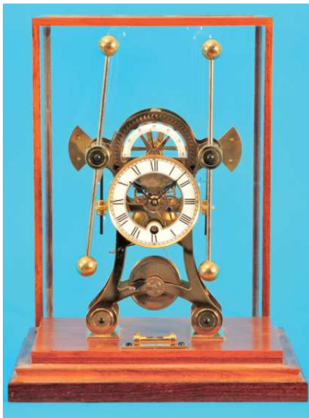
728 Dekorative, skelettierte Tischuhr mit gegenläufigen Pendeln und seltener Grasshopper-Hemmung nach John Harrison von 1735 (Nachbau), 20. Jh., die Uhr verdeutlicht die Grundidee, wie 2 gegenläufige Pendel Fehler durch Bewegungen wie auf See ausgleichen sollen, rundum verglastes Holzgehäuse, polierter, skelettiertes Werkaufbau, weißer Ziffering mit röm. Zahlen, im oberen Teil Sekundenskala, mit umlaufenden Ankerrad, mit 2 gegenläufigen Pendeln, 8-Tage-Werk mit Antrieb über Schnecke und Drahtseil, intakt (9207), M = 47 x 34 x 25 cm 1900,- -90-
