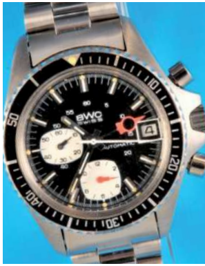
309 BWC Automac 20 Stahl-Armbanduhr-Chronograph mit zentralem Minuten-Zähler und Datum , Referenz 923003, cal. Lemania 1340, 1980er-Jahre, Stahlgehäuse mit schwarzer Drehlunette, verschraubter Kronen- und Glas-Schraubboden, Stahlglieder-Fremdband mit Faltschließe, Gebrauchsanleitung, schwarzes Zifferblatt mit Leuchtindizes, Leuchtzeiger, weißer Chronographenzeiger, zentraler Minutenzähler mit roter Spitze, weiße Skalen für kleine Sekunde bei „9“ und 12-Stunden-Zähler bei „6“, Datumsfenster bei „3“, Datumschnellschaltung, weißes Werk mit Ankergang und Rotoraufzug, Ringunruh, Flachspirale und Stoßsicherung, intakt (8877), D = 42 mm mit Krone 1000,-
