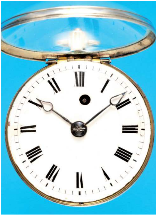
495 Große französische Silber-Spindel Taschenuhr mit Wecker auf Glocke und kleiner Sekunde , fein ziseliertes Gehäuse mit geripptem Mittelteil, Emailzifferblatt (am Rand etwas beschädigt) mit arabischen Zahlen und kleiner Sekunde bei „6“, Weckerskala bei „12“, gebläute Zeiger, vergoldetes Werk mit Spindelgang über Schnecke und Kette, filigran gearbeitete Spindelbrücke, runde Pfeiler, um 1800, intakt (8716), D = 57 mm, ca. 139 g. 650,-
