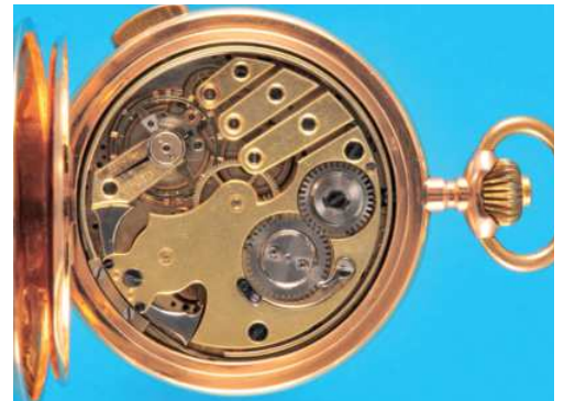
406 Goldtaschenuhr mit Sprungdeckel und \frac{1}{4} -Repetition auf zwei Tonfedern , guillochiertes, am Rand betriebenes 14-ct.-3-Deckel-Goldgehäuse, Emailzifferblatt (Beschädigung am Rand bei „11“) mit arabischen Zahlen und kleiner Sekunde, vergoldete Zeiger, vergoldetes Werk mit Ankergang, Schraubenunruh und Breguet-Spirale, Schlagabruf über Drücker, um 1900, intakt (8440), D = 54 mm, ca. 86 g. 1800,-
