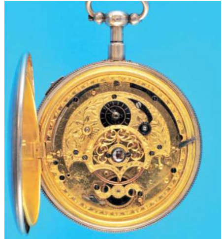
498 Silberne Spindel Taschenuhr mit Viertel-Repetition und Datum , glattes Gehäuse, sehr gut erhaltenes Emailzifferblatt mit arabischen Zahlen, zentraler Datumskreis, gebläute Breguetzeiger, feuervergoldetes Vollplatinenwerk mit filigraner Spindelbrücke, Schlagabwurf auf 2 Tonfedern über Pendant, um 1820, intakt (9433-06), D = 56 mm 1450,-
