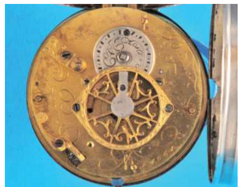
554 Breguet à Paris, silberne Spindel Taschenuhr mit bemaltem Emailzifferblatt , glattes Gehäuse, bemaltes Emailzifferblatt mit arabischen Zahlen, umgeben von polychromer Malerei mit Darstellung einer Frau mit Glas und großer Vase (am Rand etwas ausgebeßert), gebläute Zeiger, vergoldetes Vollplatinenwerk mit filigraner Spindelbrücke und versilberter Regulierringe, Spindelgang über Schnecke und Kette, um 1800, intakt (9172), D = 53 mm 1300,-
