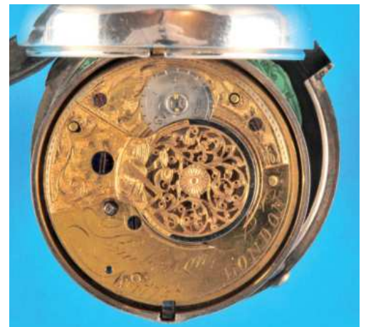
561 Silber-Spindel-taschenuhr mit bemaltem Schildpatt-Übergehäuse mit Freimaurer-Symbolen , Pemberton London (Lit. Baillie S. 247) George, um 1791, HM 1790, glattes Gehäuse, mit bemaltem Schildpatt bezogenes Übergehäuse mit Symbolen der Freimaurerei, Emailzifferblatt mit arabischen Zahlen, gebläute Zeiger, vergoldetes Werk mit Spindelgang über Schnecke und Kette, filigraner Spindelkloben, runde Pfeiler, intakt (8762), D = 57 mm 1400,-
