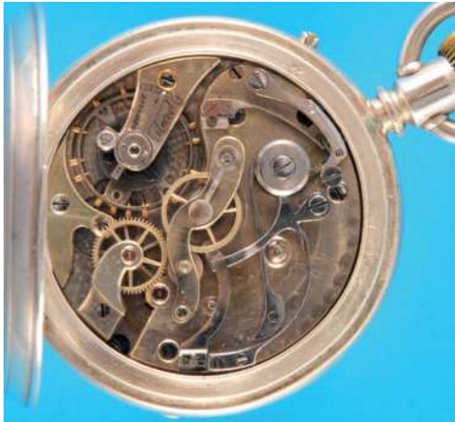
197 Silbertaschenuhr mit Chronograph , auf Zifferblatt bez. Telemetre-Chronograph , guillochiertes Silbergehäuse (am Rand beriebt) mit leerer Monogrammkartusche, Emailzifferblatt mit römischen Zahlen, kleine Sekunde, rote Chronographenskala, weißes Ankerwerk mit Kompensationsunruh und Breguet-Spirale, um 1880, intakt (7522), D = 51 mm 280,-
