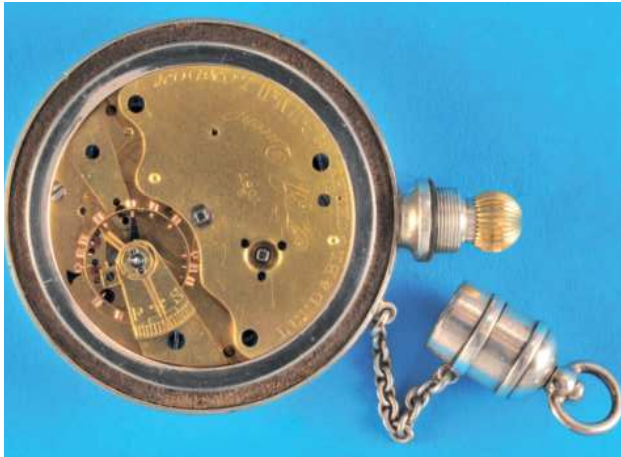
599 Lund & Blockley, To the Queen, 42 Pall Mall, London, Nr. 2/1087 mit 30-Stunden-Gangreserve-Anzeige, wasser- und staubdichte Expeditions-Beobachtungs-Taschenuhr , original im Buch Uhren der britischen Streitkräfte von Konrad Knirim auf Seite 348 ganzseitig abgebildet und beschrieben, Silbergehäuse mit Schraubdeckel, Hallmark 1884, mit Glas-Schraublinnette und Aufzugskrone unter geschraubter, mit Kette gesicherter Kapsel, vergoldetes 2/3-Platinenwerk mit Spitzzahnankergang über Schnecke und Kette, große Chronometer-Goldschraubenunruh mit gebläuter Flachspirale und Diamantdeckstein, 3 Lagersteine in verschraubten Chatons, gebläute Schrauben, intakt (9122), D = 59 mm 7000,-
