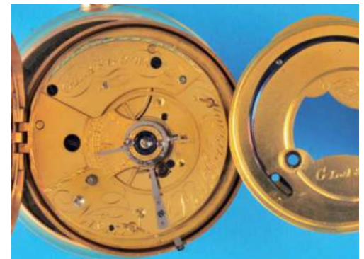
431 Philip Grierson, Glasgow, 18-ct.-Gold-Taschenuhr mit Gold-Übergehäuse und Spitzzahnankerhemmung , glatte Gehäuse, HM 1823, Emailzifferblatt mit römischen Zahlen, vergoldete Zeiger, kleine Sekunde, vergoldetes Werk unter Staubschutz mit Spitzzahnankerang über Schnecke und Kette, Unruhkloben mit großem Diamantdeckstein, 1 Lagerstein in verschraubtem Chaton, intakt (9339), D = 54 mm, ca. 159 g. 3400,-
