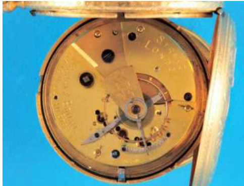
466 Upjohn & Bright Strand London (Lit. Loomes, S. 238) 1839-57, schwere goldene Schmuck-Taschenuhr mit Sprungdeckel, auf Werk signiert, doppelbödiges, beidseitig mit reichem Blumendekor graviertes 18-ct.-Gehäuse, HM 1854, Emailzifferblatt mit römischen Zahlen, kleine Sekunde, feuervergoldetes Werk unter Staubschutz, Spitzzahnankergang über Schnecke und Kette, Kompensationsunruh und Flachspirale, 3 Lagersteine in verschraubten Chatons, intakt (9264), D = 52 mm, ca. 126 g. 1900,-
