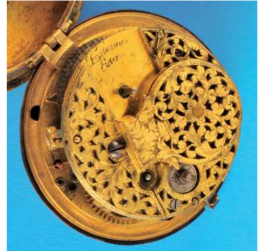
559 Oignon im reich verzierten Bronzegehäuse , sign. Estienne Ester , reich reliefiertes Bronzegehäuse, verziert mit Rocaillen, Engeln, von 2 Löwen gezogenem Prunkwagen und Kriegerern, Emailzifferblatt mit kartuschenförmigen römischen Zahlen, gebläute Zeiger, hohes, feuervergoldetes Werk mit Spindelgang über Schnecke und Kette, filigran gearbeitete Werksverzierungen und Spindelbrücke, eckige Pfeiler, um 1720, intakt (8470), D = 59 mm, ca. 164 g. 2400,-
