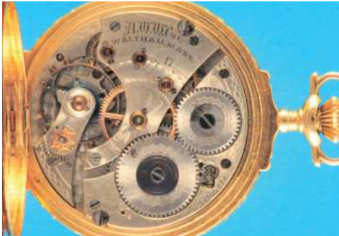
259 A.W.W.Co., Waltham Massachusetts, Mehrfarben-Gold-Schmuck-Taschenuhr mit Sprungdeckel mit Hirschmotiv und Blumendekor, 14-ct.-3-Deckel-Mehrfarben-Goldgehäuse, Sprungdeckel mit Blumendekor und leerer Monogrammkartusche, Werkdeckel mit stehendem Hirsch und Blumendekor in Mehrfarbengold, Emailzifferblatt (Risse) mit arabischen Zahlen, kleine Sekunde, gebläute Zeiger, weißes Werk mit Ankergang, Kompensationsunruh, Breguet-Spirale und Feinregulierung mittels vergoldetem Stern, 4 verschraubte Chatons, 17 Jewels, um 1900, intakt (7555), D = 49 mm, ca. 92 g. 1700,-
