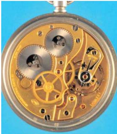
600 Seltene IWC Deckwatch für die Royal Navy mit Zentralsekunde , verschraubtes Stahlgehäuse, Werkdeckel bez. H.S.3 mit britischem Hoheitszeichen, feines Emailzifferblatt mit arabischen Zahlen und Zentralsekunde Nr. 4951, vergoldetes 3/4-Platinenwerk cal. 52 mit Ankergang Nr. 1014951, Schwanenhals-Feinregulierung, um 1940, intakt (8582), D = 52 mm 5200,-
