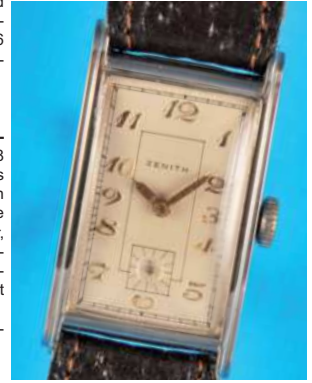
239 Zenith, rechteckige Stahlarmbanduhr , cal. Zenith 8 3/4 F, um 1939, versilbertes Zifferblatt mit vergoldeten arabischen Zahlen, kleine Sekunde, vergoldete Zeiger, weißes Formwerk mit Ankergang, Kompensationsunruh und Flachspirale, intakt (9201), M = 40 x 22 mm 600,-
