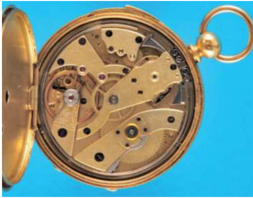
423 Goldtaschenuhr mit Viertelrepetition und Zylindergang , guillochiertes 18-ct.-Goldgehäuse mit kleinem Monogramm (kleine Dellen), Metall-Innendeckel Emailzifferblatt (Haarriss) mit römischen Zahlen, feine, gebläute Zeiger, vergoldetes Brückenwerk mit Zylindergang, Ringunruh und Flachspirale, Schlagabruf auf 2 Tonfedern über seitlichen Schieber, Schlüsselaufzug, um 1860, intakt (9284), D = 47 mm, ca. 71 g. 1300,-
