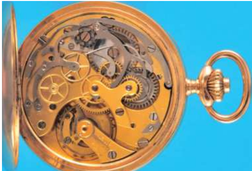
398 Longines, Goldtaschenuhr mit Chronograph und 30-Minuten-Zähler, „Cronografo Contador“ , cal. 19.73N, glattes 18-ct.-Gehäuse mit Goldcuvette, Emailzifferblatt (Haarriess) mit römischen Zahlen, 1/5-Sekunden-Einteilung, kleine Sekunde bei „6“, 30-Minuten-Zähler bei „12“, vergoldete Zeiger, weißes \frac{3}{4} -Platinenwerk mit Streifendekor, Ankergang mit Kompensationsunruh und Breguet-Spirale, Chronograph über Pendant, um 1910, intakt (9280), D = 53,5 mm, ca. 102 g. 1300,-
