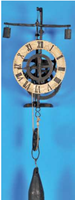
822 Gotische Eisenwanduhr mit Waagunrast und Gewichts-antrieb (Nachbau 20.Jh.), Eisenrahmen mit Abstandsdornen, Eisenräderwerk mit Spindelhemmung über großes Hemmrad mit Waagunrast und kleine Gewichten zur Gangregulierung, Gewichtsantrieb, intakt (8996), H = 26 cm 200,-
