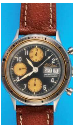
390 Hamilton „L.L.Bean“ Automatic-Armbanduhr-Chronograph mit Zählern und Kalendarium, mit Original-Etui und Gebrauchsanleitung , Referenz 9446, cal. Valjoux 7750, Stahlgehäuse mit vergoldeter Lünette, Drehlünette und Schraubboden, Original-Lederband und Dornschließe, schwarzes Zifferblatt mit weißen arabischen Zahlen und Leuchtpunkten in der Minuterie, weißer Leuchtzeiger, vergoldete Skalen für kleine Sekunde bei „9“, 30-Minuten-Zähler bei „12“ und 12-Stunden-Zähler bei „6“, Fenster für Wochentag und Datum bei „3“, Datumsnellschaltung, Ankerwerk mit Rotoraufzug, Ringunruh, Flachspirale und Stoßsicherung, intakt (8880), D = 38 mm 750,-
