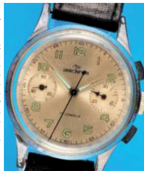
168 Wakman Watch Co. „Unichron“ Vintage Armbanduhr-Chronograph mit 30-Minuten-Zähler , cal. Venus 188, 1950er-Jahre, Gehäuse (Gebrauchsspuren) mit Edelstahl-Druckboden, im Boden und auf Werk bezeichnet Wakmann Watch Co., versilbertes Zifferblatt mit arabischen Leuchtzahlen, Leuchtzeiger, kleine Sekunde bei „9“, 30-Minuten-Zähler bei „3“, weißes Werk mit Ankergang, Ringunruh und Flachspirale, intakt (8183), D = 34 mm 330,-
