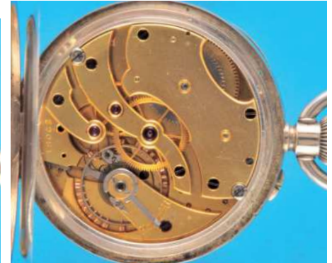
605 Große Silber-Beobachtungsuhr mit Chronometer-Hemmung , August Ericsson, Petersburg, im Original-Verkaufs-Etui, glattes Gehäuse, Emailzifferblatt mit römischen Zahlen, kleiner Sekunde, gebläute Zeiger, vergoldetes Brückenwerk mit Chronometerhemmung über Feder, intakt (3929), D = 60 mm 3300,- August Ericsson wurde im Jahre 1842 in Kristinehamn Schweden geboren. Nach seiner Uhrmacherlehre in Schweden 1865 siedelte er nach Sankt Petersburg. 1885 wird er Meister-Chronometermacher. Er zählte zu den angesehensten Uhrmachern und Händlern seiner Zeit.
