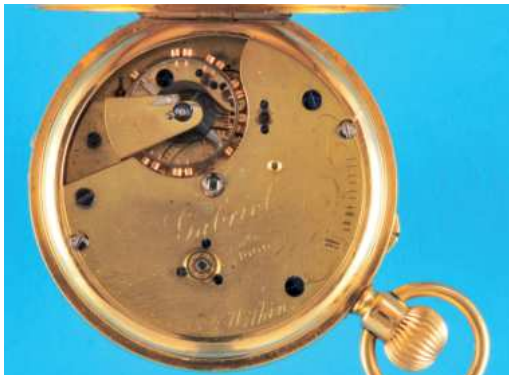
461 Gabriel London, Nr. 343/1000 schwere Goldtaschenuhr mit Sprungdeckel , glattes 18-ct.-2-Deckel-Goldgehäuse, (Lit. Loomes S. 85) William, 1875-81, feines Emailzifferblatt mit römischen Zahlen, kleine Sekunde, gebläute Zeiger, vergoldetes \frac{3}{4} -Platinenwerk mit Spitzzahnankergang, Kompensationsunruh mit Goldregulierschrauben und Breguet-Spirale, 3 Lagersteine in geschraubten Chatons, Diamantdeckstein, intakt (9286), D = 51 mm, ca.110 g. 1400,-
