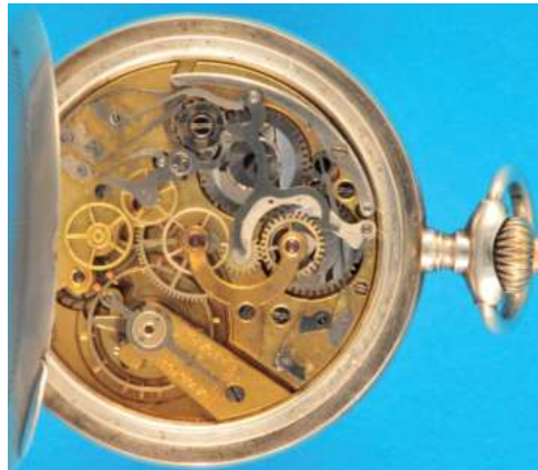
200 Silbertaschenuhr mit Chronograph und 30-Minuten-Zähler , guillochiertes Gehäuse mit leerer Monogrammkartusche, Emailzifferblatt mit arabischen Zahlen, kleine Sekunde bei „6“, 30-Minuten-Zähler bei „12“, gebläute Zeiger, vergoldetes Werk mit Ankergang, Schraubenunruh und Breguet-Spirale, um 1900, intakt (8406), D = 52 mm 300,-
