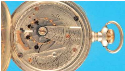
215 American Waltham Watch Co. , große Taschenuhr im glatten Crescent Sterling-Gehäuse (leichte Dellen), Emailzifferblatt mit arabischen Zahlen und roter Minuterie, kleine Sekunde, gebläute Zeiger, fein ziseliertes weißes Werk mit Ankergang, Kompensationsunruh und Breguet-Spirale, 17 Jewels, um 1900, intakt (8756), D = 54 mm, ca. 134 g. 240,-
