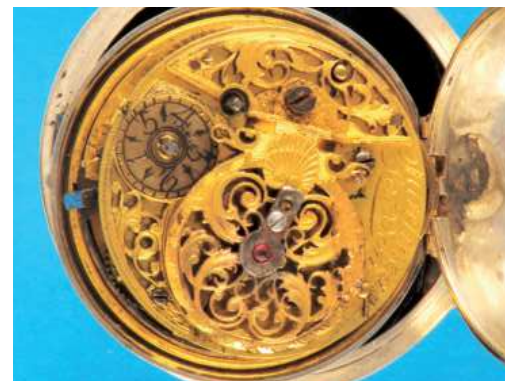
503 Englische Silber-Sackuhr mit Übergehäuse , sign. Martineau London (Lit. Loomes S. 155) Joseph, jun. ? London, 1750, glatte Gehäuse, Emailzifferblatt mit römischen Zahlen und großer arabischer Minuterie, vergoldete Zeiger, vergoldetes Werk mit Spindelgang über Schnecke und Kette, graviertes, filigran gearbeiteter Kloben und Werksverzierung, eckige Pfeiler, intakt (8760), D = 48 mm 1400,-
