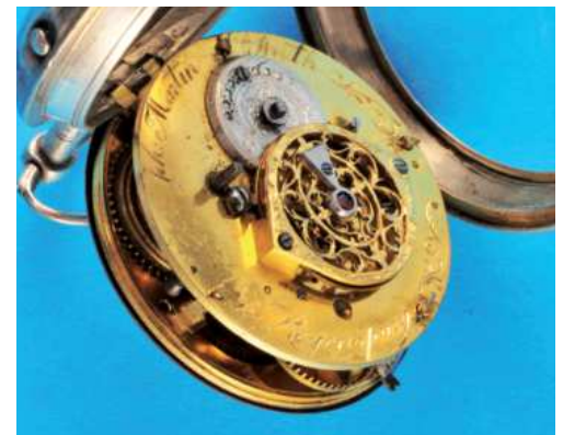
485 Französische Silber-Spindeltaschenuhr mit silberner Taschenuhrkette, im Mittelteil ziseliertes Silbergehäuse mit leerer, ovaler Monogrammkartusche, Emailzifferblatt (restauriert) mit arabischen Zahlen, arabische Teilminuterie, vergoldete Zeiger, vergoldetes Werk mit Spindelgang über Schnecke und Kette, filigran gearbeitete Spindelbrücke, versilberte Regulierringe, um 1800, intakt (8698), D = 51 mm 220,- 486 Silberne deutsche Spindeltaschenuhr, auf Zifferblatt und Werk sign. Joh. Martin Spaeth in Regensburg (Lit. Abeler S.512), ca. 1745-1773, glattes Gehäuse, Emailzifferblatt mit römischen Zahlen, vergoldete Zeiger, feuervergoldetes Spindelwerk mit Schnecke und Kette, eckige Pfeiler, filigran gearbeitete Spindelbrücke, intakt (8942-07), D = 58 mm 750,-
