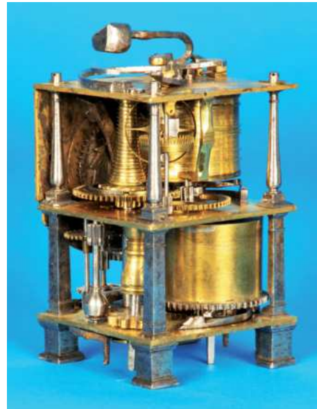
846 Kleine Renaissance-Türmchenuhr mit Stundenschlag auf Glocke und Waagunrast, um 1600, auf gestuftem Sockel stehendes, feuervergoldetes, allseitig reich mit Girlanden und figuralen Darstellungen verziertes Gehäuse, kuppelförmiger Abschluss, durchbrochen gearbeitet als Schalllöcher, Zifferblatt mit römischen Zahlen, ausgeschnittener Eisenzeiger, hoch rechteckiges Werk mit übereinander liegendem Lauf- und Schlagwerk, Antrieb über Schnecke und Darmsaite, gehfähig (7690), H = 18 cm 11000,- Der spätere Umbau auf Hinterpendel wurde zurückgebaut
