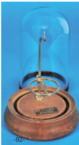
721 Astatisches Nadel- paar unter Glas- sturz, Abteilung Feinmechanik der Deutschen Uhrma- cherschule Glas- hütte (Sa.), (7773), H = 20 cm mit Glassturz 360,-
