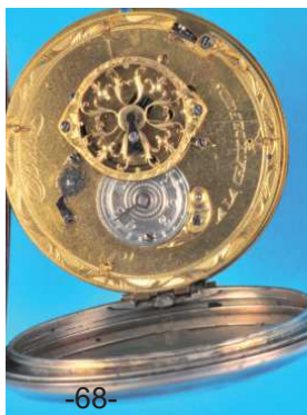
501 Silberne Spindeltaschenuhr mit Kalendarium , auf Werk signiert Borlé à la Chaux-de-Fonds , glattes Gehäuse, Emailzifferblatt (kleine Ausbesserung am Aufzugsloch) mit arabischen Zahlen, kleine Skalen für die kleine Sekunde, Datum, Wochentag und Monatsangaben, vergoldete Zeiger, vergoldetes Vollplatinenwerk mit Spindelgang über Schnecke und Kette, runde Pfeiler, filigrane Spindelbrücke, intakt (7762), D = 60 mm 1200,-
