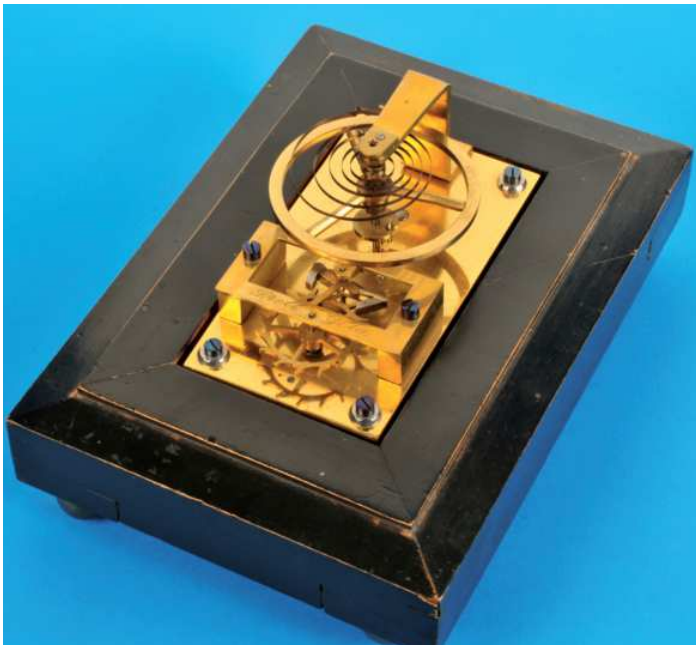
705 Gangmodell von Walter Prell, Gera, Schüler an der Deutschen Uhrmacherschule Glashütte, mit Kopie des Abgangszeugnisses von 1902, „Schweizer Kolbenzahn-Ankerhemmung“, von vier vergoldeten Füßen getragener, rechteckiger Holzsockel mit Plexiglashaube (später), Gangmodell mit rechteckiger Messinggrundplatte, Ankergangmodell mit großer Unruh und Antrieb über Federhaus, intakt (7774), M = 19 x 14 x 11,5 cm 2400,-
