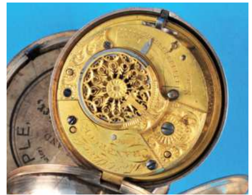
515 Silberne Spindeltaschenuhr mit Übergehäuse, Tho(ma)s Ollive Cranbrook 17000, (Lit. Baillie S. 238) 1777-95, glatte Gehäuse, Emailzifferblatt (Risse) mit arabischen Zahlen, vergoldete Zeiger, vergoldetes Werk mit Spindelgang über Schnecke und Kette, filigran gearbeiteter Spindelkloben, intakt (7508), D = 59 mm 380,-
