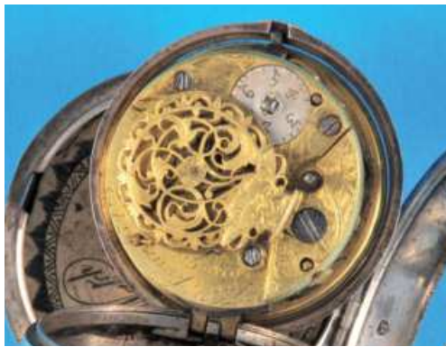
509 Silberne Spindeltaschenuhr in doppeltem Gehäuse, Thomas Rumsey London, ca. 1772, glatte Gehäuse, Emailzifferblatt mit römischen Zahlen, gebläute Zeiger, vergoldetes Vollplatinenwerk mit Spindelgang über Schnecke und Kette, eckige Pfeiler, filigraner Spindelkloben, intakt (5122), D = 50 mm 500,-
