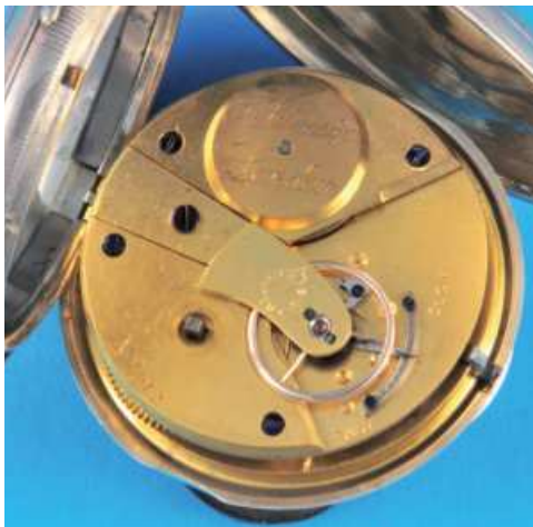
197 Englische Silbertaschenuhr mit 8-Tagewerk , im Holzetui, J.Silverstone London, glattes Gehäuse, Emailzifferblatt mit römischen Zahlen, kleine Sekunde, vergoldete Zeiger, vergoldetes Werk mit 8-Tage-Spitzzahnankergang, intakt (4717), D = 53 mm 550,-
