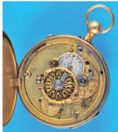
448 Goldene Spindeltaschenuhr mit Viertel-Repetition , Frères Esquivillon, mit Sonnenstrahlen verziertes Gehäuse, Emailzifferblatt mit arabischen Zahlen, gebläute Zeiger, vergoldetes Vollplatinenwerk mit Spindelgang, filigrane Spindelbrücke, Schlagabruf auf 2 Tonfedern über Pendant, intakt (6195), D = 52 mm 1400,-
