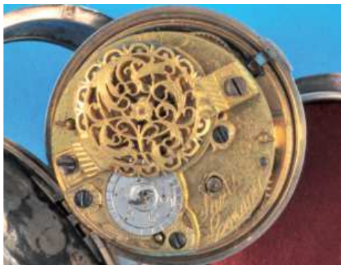
511 Silberne Spindeltaschenuhr mit Silberübergehäuse und Datum, auf Werk sign. Tarts London (Lit. Baillie S. 308), ca. 1778, glatte Gehäuse, Emailzifferblatt (Risse) mit römischen Zahlen, arabischer Arkadenminuterie, Datumsfenster, gebläute Poker- und Beetle-Zeiger, feuervergoldetes Vollplatinenwerk mit Schnecke und Kette, eckige Pfeiler, filigrane Spindelbrücke, intakt (1558), D = 52 mm 800,-
