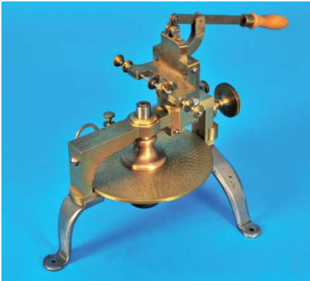
732 Kleine antike Raderschneidmaschine, H.Woernle, Stuttgart, auf Eisenfüßen stehende Schneidmaschine mit Teilscheibe, D = 13,5 cm (7664), H = 23 cm 1500,-
