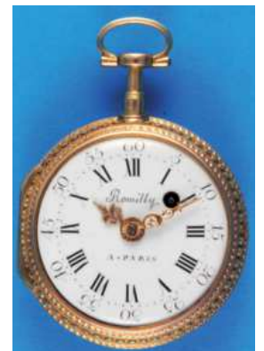
547 Goldene Spindeltaschenuhr mit Mehrfarbengolddekor , sehr gut erhaltenes, reich verziertes Gehäuse, Emailzifferblatt (am Rand beschädigt) mit römischen Zahlen und großer arabischer Minuterie, vergoldete Zeiger, vergoldetes Werk mit Spindelgang über Schnecke und Kette, filigran gearbeitete Spindelbrücke, silberne Regulierskala, um 1780, intakt (6872), D = 40 mm 1000,-
