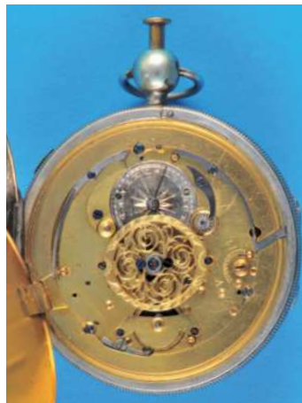
502 Silberne Spindeltaschenuhr mit Viertelrepetition, Lepine & Fils , vergoldetes Werk mit Spindelgang, guillochiertes Gehäuse, Emailzifferblatt mit arabischen Zahlen, gebläute Zeiger, feuervergoldetes Vollplatinenwerk mit Spindelgang, filigrane Spindelbrücke, Schlagabruf auf 2 Tonfedern über Pendant, intakt (5006), 1100,-
