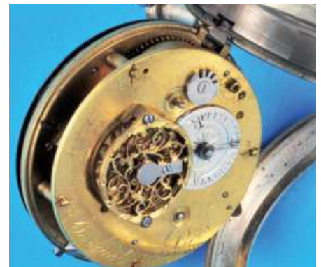
485 Jean Breguet à Paris, versilberte Spindeltaschenuhr mit Stundenselbstschlag und Stunden-Repetition auf Glocke , glattes Gehäuse mit Schalllöchern, Emailzifferblatt (an den Aufzügen etwas beschädigt), arabische Zahlen, gebläute Breguet-Zeiger, vergoldetes Werk mit Spindelgang über Schnecke und Kette, filigran gearbeitete Spindelbrücke, um 1800, intakt (7512), D = 55 mm 1100,-
