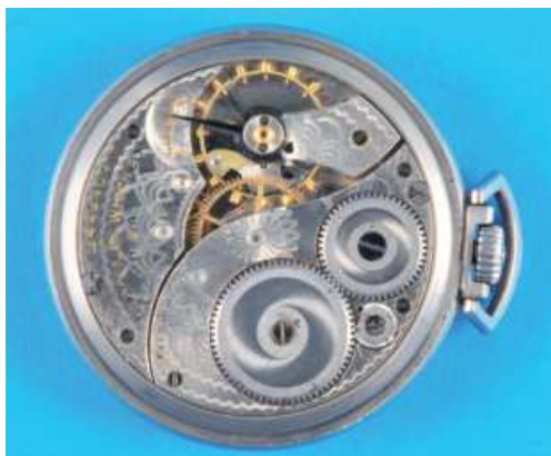
266 Elgin Freimaurer-Frackuhr , glattes Metallgehäuse mit aufgedrücktem Boden, lackiertes Zifferblatt mit goldfarbenen Freimaurersymbolen als Zahlenindikation, im Zentrum Wappen des amerikanischen Tempelordens mit Inschrift "In Hoc Signo Vincas" (in diesem Zeichen wirst du siegen), kleine Sekunde, gebläute Zeiger, weißes Werk mit Ankergang, Kompensationsunruh mit Schrauben und Breguet-Spirale, 7 Jewels, um 1920, intakt (7674), D = 44 mm 330,-
