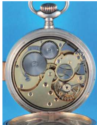
234 Silbertaschenuhr mit 1/4-Repetition auf 2 Tonfedern , auf Zifferblatt sign. A.Lugrin und Fabrikmarke A.Lugrin unter dem Schlaghammer , glattes Silbergehäuse mit seitlichem Drücker für Repetition, Emailzifferblatt mit arabischen Zahlen, kleine Sekunde, vergoldete Zeiger, vergoldetes Werk mit Ankergang, Schraubenunruh mit Breguet-Spirale, um 1900, intakt (7348), D = 51 mm 1200,-
