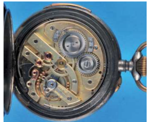
231 Große Metall-Taschenuhr mit 1/4-Repetition , brüniertes Gehäuse, Emailzifferblatt mit arabischen Zahlen, rote Minuterie, kleine Sekunde, vergoldetes Brückenwerk mit Ankergang, Kompensationsunruh und Breguet-Spirale, 1/4-Repetition auf zwei Tonfedern über Schieber, um 1900, intakt (6861), D = 58 mm 550,-
