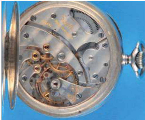
226 Paul Ditisheim, Solvil, silberne Taschenuhr mit Affix-Kompensationsunruh , auf Innendeckel bez. Patentada Compensacion , glattes Sterlingsilber-Gehäuse, versilbertes Zifferblatt mit goldfarbenen arabischen Zahlen, kleine Sekunde, gebläute Zeiger, weißes Brückenwerk mit Ankergang, Affix-Kompensationsunruh und Breguet-Spirale, um 1910, intakt (7709), D = 50 mm 240,-
