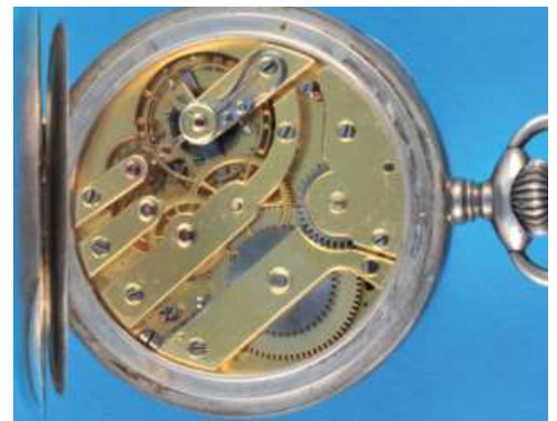
232 Schweizer Schuluhr mit Tulasilberkette , bezeichnet auf Zifferblatt Ecole d'Horlogerie Neuchâtel , glattes 800er-Silbergehäuse, Emailzifferblatt mit arabischen Zahlen, kleine Sekunde, gebläute Breguet-Zeiger, vergoldetes Brückenwerk mit Ankergang, Kompensationsunruh und Breguet-Spirale, intakt (7276), D = 53 mm, dazu feine Tulasilberkette mit vergoldeten Zwischengliedern, L = 42 cm 550,-
