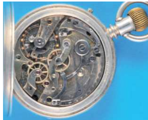
222 Silbertaschenuhr mit Chronograph , auf Zifferblatt bez. Telemetre-Chronograph , guillochiertes Silbergehäuse (am Rand berieben) mit leerer Monogrammkartusche, Emailzifferblatt mit römischen Zahlen, kleine Sekunde, gebläute Zeiger, rote Chronographenskala, weißes Ankerwerk mit Kompensationsunruh und Breguet-Spirale, um 1900, intakt (7522), D = 51 mm 300,-
