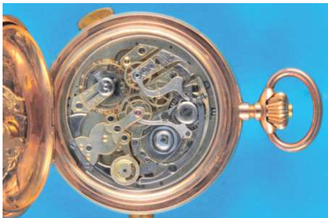
431 Große Goldtaschenuhr mit Sprungdeckel mit ¼-Repetition, Chronograph und astronomischen Indikationen mit Mondphasen-Kalender , 18-ct.-3-Deckel-Roségoldgehäuse (Dellen), auf Innendeckel sign. Silencieuse Orient, Emailzifferblatt mit arabischen Zahlen, vergoldete Zeiger, zentraler Chronographenzeiger, Fenster für Wochentag und Monat, Datumsskala bei „12“, kleine Sekunde bei „6“ mit Mondphase, vergoldetes Werk unter Glasschutz mit Ankergang, Kompensationsunruh mit Breguet-Spirale, ¼-Repetition auf zwei Tonfedern, um 1900, intakt (7136), D = 54 mm, ca. 129 g 3800,-
