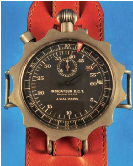
702 Bombenabwurfuhr, Minerva, für die französische Luftwaffe, „Chronografo di Retorno“, Indicateur B.C.V. Breveté S.G.D.G., J. Vial-Paris, Nickelgehäuse mit vier Schlaufen zum Einhängen in eine Cockpit-Halterung, Drehlunette mit rotem Pfeil mit Leuchtmasse, schwarzes Zifferblatt mit äußerem Sekundenring 1-30, innerer Ring mit 60-Sekunden-Skala, Hilfszifferblatt für 15-Minuten-Zähler bei „12“, zentrale Stoppsekunde, vergoldetes Ankerwerk mit monometallischer Ringunruh und Flachspirale, Stoppfunktion über Schaltrad, 30er-Jahre, intakt (7321), D = 63 mm (Dreh-lunette) 1300,- Lit. Knirim, Militär Uhren, S. 91
