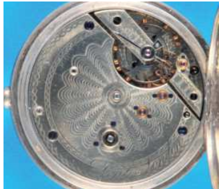
199 Silbernes Taschenuhr-Chronometer mit kugelförmiger, gebläuter Spirale , auf Werk und Zifferblatt sign. Dent London, glattes Gehäuse, sehr gut erhaltenes Emailzifferblatt mit römischen Zahlen, kleine Sekunde, ziseliertes Nickel-4/5-Platinenwerk Nr. 43796 mit Schnecke und Kette, Wippenchronometer, Kompensationsunruh mit Goldregulierschrauben, seltene, kugelförmige, gebläute Spirale mit Endkurven, goldene Laufräder, 3 geschraubte Chatons, Schlüsselaufzug, um 1880, intakt (5841), D = 53 mm 1400,-
