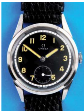
566 Seltene Omega Stahlarmbanduhr, cal. 26.5 SOB T2, ca.1939, Stahlgehäuse mit Druckboden, schwarzes Zifferblatt mit arabischen Leuchtzahlen, Leuchtzeiger, kleine Sekunde, weißes Werk mit Ankergang, Kompensationsunruh und Breguet-Spirale, intakt (7877), D = 34,5 mm
