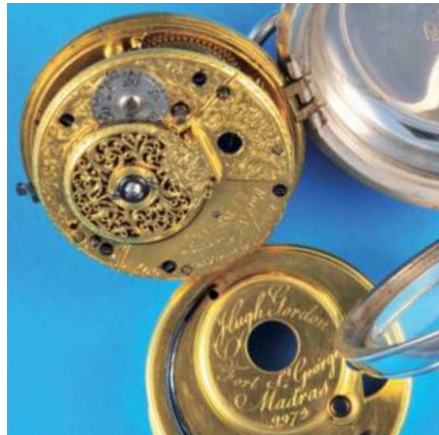
198 Silbertaschenuhr , Hugh Gordon, Madras, doppelbödiges Gehäuse, Emailzifferblatt mit römischen Zahlen, kleine Sekunde, vergoldete Zeiger, feuervergoldetes Vollplatinenwerk mit Schnecke und Kette, Duplexhemmung, filigraner Kloben mit Diamantdeckstein, Staubschutz, intakt (3287), D = 55 mm 550,-
