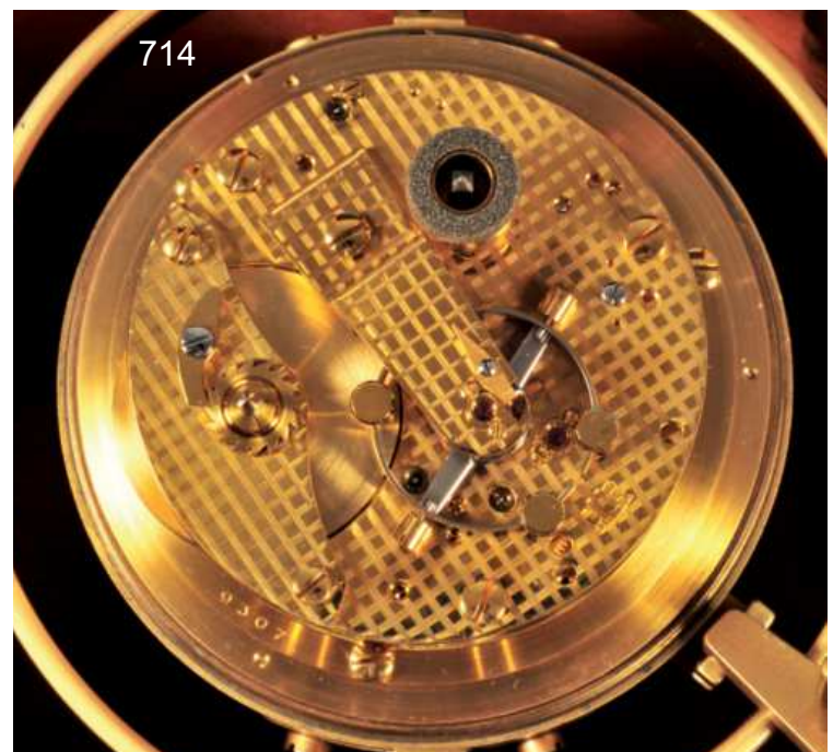
714 GUB Glashütte, Marine-Chronometer im 2-tlg. Holzgehäuse mit Werkprüfschein von 1989 und Werkpass in 3 Sprachen (deutsch, englisch, russisch), kardanisch gelagerte Uhrtrommel, versilbertes Zifferblatt mit römischen Zahlen, vergoldete Zeiger kleine Sekunde bei „6“ und 56-Stunden-Gangreserve bei „12“ mit gebläuten Zeigern, vergoldetes Werk mit Chronometerhemmung über Feder, Schnecke und Stahlband mit Gegengespierr, Kompensationsunruh mit zylindrischer Spirale, intakt (7066), M = 18,5 x 18,5 x 18,5 cm 1500,-
