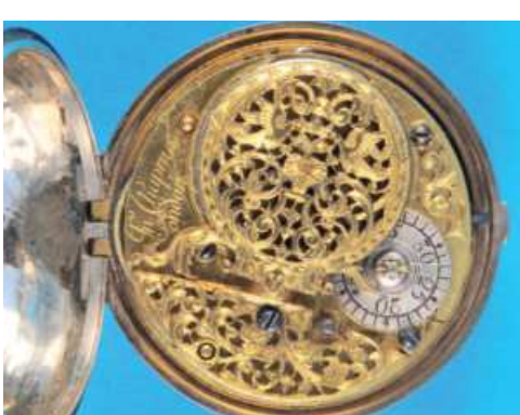
513 Englische Sackuhr, sign. J(oh)n Chapman London (Lit. Baillie S. 55), glattes Silbergehäuse (Übergehäuse fehlt), Emailzifferblatt mit römischen Zahlen, arabische Minuterie, vergoldete Zeiger, hohes, vergoldetes Werk mit Spindelgang über Schnecke und Kette, filigran gearbeitete Spindelbrücke mit Vögeln, silberne Regulierscheibe, eckige Pfeiler, Werkverzierungen, Mitte 18.Jh., intakt (7594), D = 48 mm 650,-
