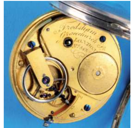
201 Silberne Taschenuhr , auf Werk und Zifferblatt sign. Frodsham, Gracechurch Str., London (Lit. Baillie S.113), ca. 1785-1849, doppelbödiges Gehäuse, sehr gut erhaltenes Emailzifferblatt mit römischen Zahlen, kleine Sekunde, Goldzeiger, vergoldetes 3/4-Platinenwerk mit Spitzzahnankergang, Schlüsselaufzug, um 1828, intakt (751), D = 53 mm 700,-
