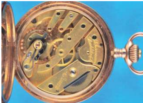
318 Goldtaschenuhr mit Sprungdeckel, J.Assmann Glashütte Nr. 15273 , glattes 14-ct.-Goldgehäuse, Emailzifferblatt mit arabischen Zahlen, kleine Sekunde, vergoldete Zeiger, Ankergang mit Goldausgleichsanker und Ankerrad, intakt (5776), D = 52 mm 2000,-
