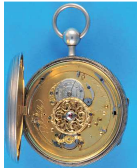
506 Große silberne Spindeltaschenuhr mit Viertel-Repetition, Romilly à Paris (Lit. Baillie S. 274) ca. 1714-1794, glattes Gehäuse, Emailzifferblatt mit arabischen Zahlen, vergoldete Zeiger, vergoldetes Vollplatinenwerk mit Spindelgang, filigrane Spindelbrücke, Schlagabruf auf 2 Tonfedern über Pendant, intakt (2245), D = 58 mm 1100,-
