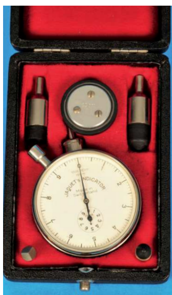
726 Jaquet's Indicator, Drehzahl im Origina- letui mit verschiede- nen Aufsätzen, für 100, 1000 und 10000 Umdrehungen, schwarz lackiertes Ni- ckelgehäuse, Modell 253, weißes Zifferblatt mit zentralem, gebläuten Zeiger, im unteren Teil Skala für 10000 Umdrehungen, Kurz- zeitmesser mit Aufzug über Drücker am Ge- häuserand (7180), D = 60 mm 70,-
