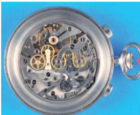
220 Neuwertige Lemania Nickeltaschenuhr mit Chronograph und 30-Minuten-Zähler , mit Original-Etikett, unbenutzte Lagerware, verharzt, glattes Nickelgehäuse, versilbertes Zifferblatt mit arabischen Zahlen, kleine Sekunde bei „6“, 30-Minuten-Zähler bei „12“, rote Tachymeter-Skala, weißes Ankerwerk mit Kompensationsunruh und Breguet-Spirale, intakt (7655), D = 47 mm 1200,-
