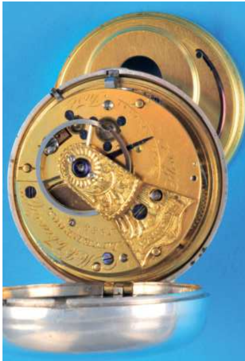
196 Große Silbertaschenuhr mit Rechenankergang und Übergehäuse , M.J.Tobias Liverpool (Lit. Baillie S. 314), ca. 1810-1829, glatte Gehäuse, sehr gut erhaltenes Emailzifferblatt mit römischen Zahlen, gebläute Zeiger, kl.Sek., vergoldetes Vollplatinenwerk mit Schnecke und Kette, runde Pfeiler, gravierter Kloben mit Diamantdeckstein, Staubschutz, intakt (740), D = 55 mm 1200,-
