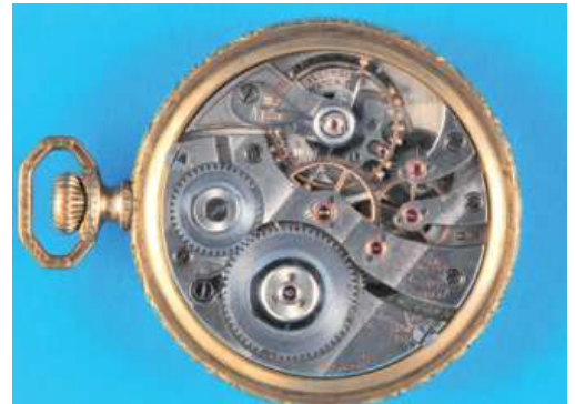
271 Illinois Watch Co., Sangamo Special Motor Barrel , reich verziertes, verschraubtes Elgin Double-Stock-Gehäuse „Ramona“, 3-teiliges Emailzifferblatt (Risse) mit fetten arabischen Zahlen, kleine Sekunde, gebläute Zeiger, Zeigerstellhebel und unter verschraubter Lunette bei „1“, weißes Werk mit Ankergang, Kompensationsunruh mit Schrauben, Breguet-Spirale und Feinregulierung, 23 Jewels, verschraubte Chatons, um 1920, intakt (7708), D = 49 mm 240,-
