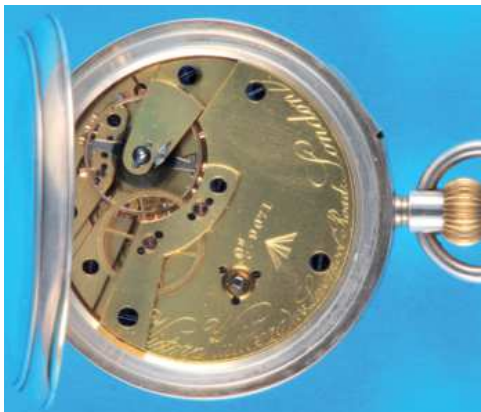
573 Große Silber-Beobachtungsuhr, Victor Kullberg, London, mit britischem Hoheitszeichen, glattes Gehäuse mit Goldscharnier, Emailzifferblatt mit römischen Zahlen, arabische Minuterie, Zentralsekunde, gebläute Zeiger, vergoldetes Werk mit Spitzzahnankergang und großer Kompensationsunruh, intakt (4091), D = 58 mm 3800,-
