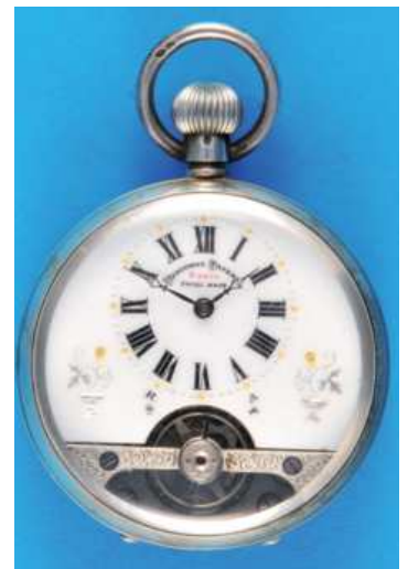
114 Silbertaschenuhr mit 8-Tage-Werk . Hebdomas , mit Blumendekor reich verziertes, reliefiertes Gehäuse, Emailzifferblatt mit römischen Zahlen, gebläute Zeiger, im unteren Teil sichtbare Unruhbrücke mit Ankergang, intakt (3275), D = 48 mm 160,-
