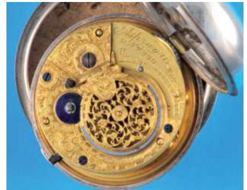
516 Silber-Spindeltaschenuhr mit Übergehäuse, sign. Asprey, Olney (Lit. Loomes S. 7, Ebenezer) 1798, glatte Gehäuse, Emailzifferblatt mit römischen Zahlen, vergoldete Zeiger, reich ziseliertes, vergoldetes Werk mit filigran gearbeitetem Spindelkloben, Spindelgang über Schnecke und Kette, runde Pfeiler, intakt (6618), D = 56 mm 600,-
