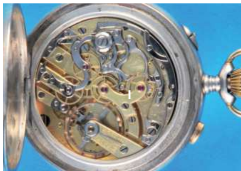
218 Große Silbertaschenuhr mit Chronograph, Schleppzeiger (Rattrapante) und 60-Minuten-Zähler , glattes Silbergehäuse, Emailzifferblatt mit römischen Zahlen, kleiner Sekunde bei „6“ und 60-Minuten-Zähler bei „12“, vergoldete Zeiger, vergoldetes Werk mit Ankergang, Kompensationsunruh mit Breguet-Spirale, um 1900, intakt (6862), D = 57 mm 950,-
