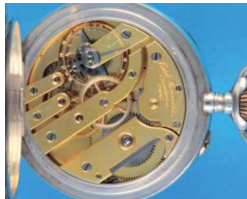
223 Silbertaschenuhr „Schuluhr“ , auf Cuvette graviert „Angefertigt i.d. Handwerker & Kunstgewerbeschule zu Altona 1908 von Carl Thormählen, Elshorn“, glattes Gehäuse, Emailzifferblatt mit arabischen Zahlen, kleine Sekunde, gebläute Zeiger, vergoldetes Brückenwerk mit Ankergang, intakt (7749), D = 53 mm 1200,-
