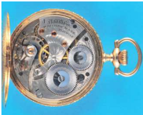
274 Reich gravierte Jugendstil-Goldtaschenuhr mit Sprungdeckel, A.W.W.Co. Waltham, Mass., mit Vögeln und Blumendekor reich graviertes 14 ct.-3-Deckel-Goldgehäuse, Emailzifferblatt mit arabischen Zahlen, kleine Sekunde, gebläute Zeiger, weißes Werk mit Ankergang, Feinregulierung mittels Stern, um 1900, intakt (6633), D = 48 mm 1350,-
