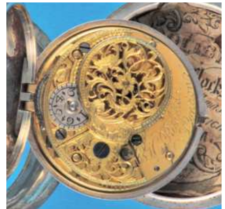
484 Silberne Spindeltaschenuhr mit Übergehäuse , H. Richards London, glatte Gehäuse, Emailzifferblatt mit arabischen Zahlen, gebläute Poker & Beetle-Zeiger, feuervergoldetes Spindelwerk mit eckigen Pfeilern und filigran gearbeiteter Spindelbrücke, silberne Regulierscheibe, um 1780, intakt (7713), D = 49 mm 950,-
