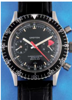
255 Croton Chronomaster Aviator Sea Diver Stahlarmbanduhr mit Schraubboden und Drehlunette , Ref. 105-26792, cal. Valjoux 23, 60er-Jahre, schwarzes Zifferblatt mit Leuchtindizes, Leuchtzeiger, roter Chronographenzeiger, kleine Sekunde bei „9“, Schaltrad-Chronograph mit 30-Minuten-Zähler mit Regatta-Sektor bei „3“, weißes Werk mit Ankergang, Ringunruh, Flachspirale und Stoßsicherung, intakt (7580), D = 38 mm 390,-
