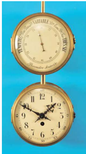
851 Janus-Wanduhr mit Aneroid-Barometer, Barometer signiert N. Martel, Paris, runde Messinggehäuse, beidseitig mit Emailzifferblättern mit arabischen Zahlen und arabischer Minuterie (restauriert), gebläute Zeiger, Werk mit Ankergang, darüber beidseitiger Barometer mit 2 Druckdosen, um 1900, intakt (6572), D = 16,5 cm 650,-
