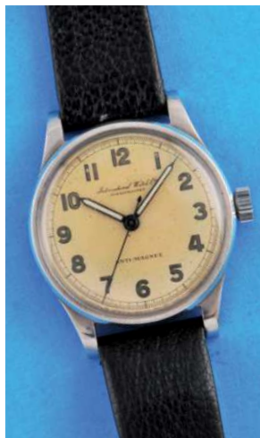
561 IWC Anti-Magnet. Stahl-Armbanduhr, seltenes cal. 61, um 1939, Stahlgehäuse, versilbertes Zifferblatt mit arabischen Leuchtzahlen, Leuchtzeiger, Zentralsekunde, Ankerwerk mit Schraubenunruh und Breguet-Spirale, intakt (7728), D = 30 mm
