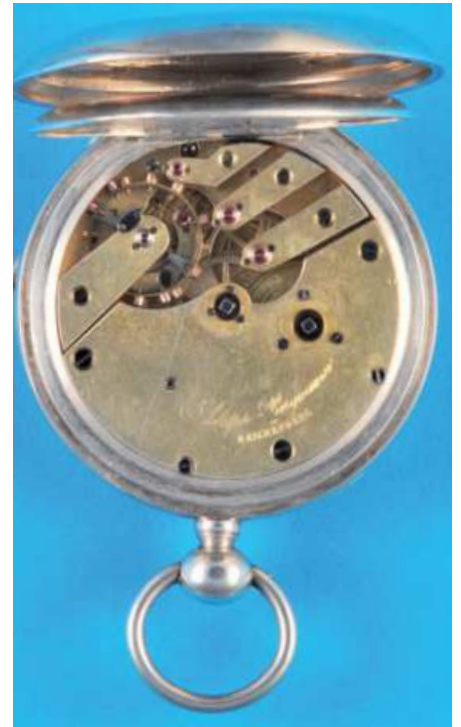
202 Silbertaschenuhr mit Chronometerhemmung über Schnecke und Kette , auf Werk sign. Joseph Bergmann, Reichenberg, glattes Gehäuse, Emailzifferblatt (1 feiner Riss), römische Zahlen, kleine Sekunde vergoldetes 3/4-Platinenwerk mit Schnecke und Kette, Chronometerhemmung mit Wippe, freischwingende, zylindrische, gebläute Spirale, 5 geschraubte Chatons, Schlüsselaufzug, um 1860, intakt (1466), D = 52 mm 1900,-
