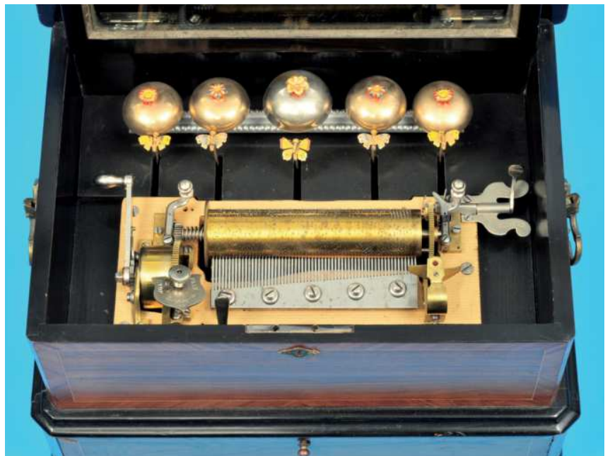
736 Walzenspiel-Automat mit vier Melodien und fünf Glocken, dekoratives Edelholzgehäuse mit Blumenintarsien und seitlichen Messingtraggriffen, im unteren Teil Schublade für Wechselwalzen (fehlen), Zungenspielwerk mit Messingstiftwalze, Glockenhämmer mit bunt bemalten Schmetterlingen verziert, 19.Jh., intakt (7535-07), M = 34 x 31 x 28 cm 750,-
