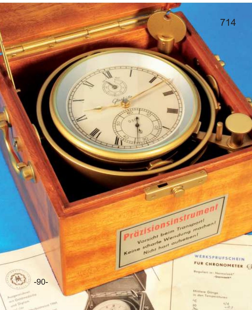
714 GUB Glashütte, Marine-Chronometer im 2-tlg. Holzgehäuse mit Werkprüfschein von 1989 und Werkpass in 3 Sprachen (deutsch, englisch, russisch), kardanisch gelagerte Uhrtrommel, versilbertes Zifferblatt mit römischen Zahlen, vergoldete Zeiger kleine Sekunde bei „6“ und 56-Stunden-Gangreserve bei „12“ mit gebläuten Zeigern, vergoldetes Werk mit Chronometerhemmung über Feder, Schnecke und Stahlband mit Gegengespierr, Kompensationsunruh mit zylindrischer Spirale, intakt (7066), M = 18,5 x 18,5 x 18,5 cm 1500,-
