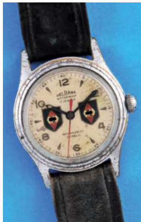
559 Seltene Delbana Stahl-Armbanduhr mit Zentralsekunde, Zifferblatt mit Wimpeln der Hitlerjugend, Ref. 1009-74, cal. AS 1194, um 1938, verschraubtes Gehäuse, versilbertes Zifferblatt mit arabischen Zahlen, im Zentrum mit 2 Wimpeln der Hitlerjugend, Leuchtzeiger, Ankerwerk mit direkter Zentralsekunde, Schraubenunruh und Flachspirale, intakt (7733), D = 30 mm
