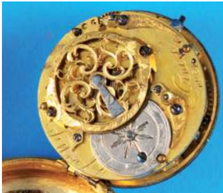
481 Vergoldete Schweizer Spindeltaschenuhr, Le Frères Wiss, Genève (Lit. Baillie S. 346) um 1775, graviertes, vergoldetes Gehäuse (Vergoldung stark abgerieben), lackiertes Zifferblatt (ersetzt und Kratzer) mit arabischen Zahlen, vergoldete Zeiger, feuervergoldetes Werk mit Spindelgang über Schnecke und Kette, filigran gearbeitete Spindelbrücke, silberne Regulierscheibe, intakt (7712), D = 44 mm 450,-
