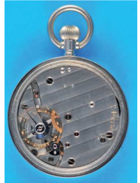
595 Große Nickeltaschenuhr mit verschraubtes Gehäuse und Staubschutz , Emailzifferblatt mit arabischen Zahlen, kleine Sekunde, gebläute Zeiger, Nickelwerk mit Genfer Streifen und Ankergang mit großer Kompensationsunruh und Breguet-Spirale, intakt (3649), D = 63 mm 1100,-
