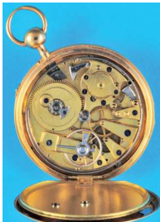
446 Große Goldtaschenuhr mit 1/4-Repetition und Zylinderhemmung , guillochiertes, beriebenes 18-ct.-Goldgehäuse mit Metallinnendeckel, Emailzifferblatt (bei „9“ kleine Beschädigung), arabische Zahlen, gebläute Zeiger, Repetitionsauslösung über Pendant, vergoldetes Werk mit Zylindergang, Schlagabruf auf 2 Tonfedern, um 1840, intakt (6821), D = 57 mm 1300,-
