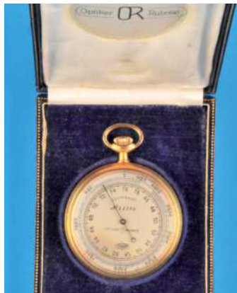
722 Taschen-Barometer im Originaletui, be- zeichnet „Compensirt, Optiker Ruhn- ke“, vergoldetes Ge- häuse in Taschenuhr- form, versilberte Skala, äußerer Ring für Höhenmeter, gebläuter zentraler Zeiger (7514), D = 53 mm 90,-
