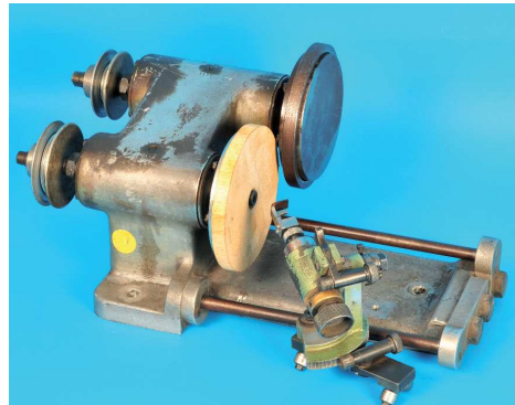
630 Lappediermaschine mit zwei Spindeln mit Handapparat zum Schleif- und Polierwinkel über alle Achsen einzustellen (5721) 1200,-
