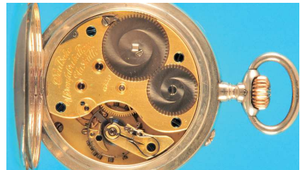
304 Silbertaschenuhr, Deutsche Uhrenfabrikation Glashütte, A. Lange & Söhne Nr. 65776, glattes Gehäuse, Emailzifferblatt mit arabischen Zahlen, kleine Sekunde, vergoldete Zeiger, vergoldetes 3/4-Platinenwerk mit Ankergang, Goldanker und Goldankerrad, Schwanenhals-Feinregulierung, intakt (5429), D = 54 mm 900,-
