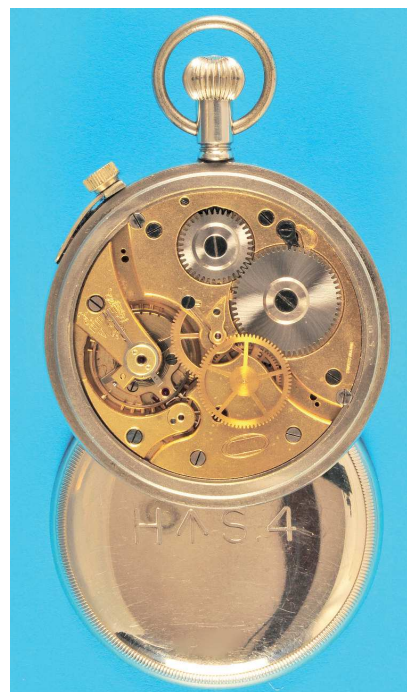
545 Militär-Beobachtungstaschenuhr, M. Golay & Son London , verschraubtes Metall-Gehäuse mit schwarzer Drehlunette, auf Gehäuse bez. H.S.4, Emailzifferblatt mit römischen Zahlen, Zentralsekunde über seitlichen Schieber zu stoppen, gebläute Zeiger, vergoldetes Werk mit Ankergang, intakt (6386), D = 62 mm 450,-
