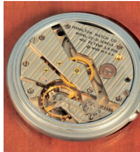
602 Bord-Chronometer mit Gangreserve-Anzeige im Holzkästchen , auf Zifferblatt sign. Hamilton Watch Co., Lancaster, PA. U.S.A., im 2-tlg. Holzkästchen, verschraubtes Gehäuse bez. Bureau of Ships, U.S.Navy, N156, 1941 Chronometer Watch , versilbertes Zifferblatt (leicht fleckig) mit arabischen Zahlen, gebläute Zeiger, kleine Sekunde bei der "6", Gangreserve-Anzeige bei der "12", Nickel-Brückenwerk mit Streifenfeder, Hamilton Watch Co., Modell 22, 21 Jewels, 6 Adjustierungen, Ankerwerk mit Kompensationsunruh, Feinregulierung mittels Exzentrerscheibe, intakt (6475), D = 70 mm 980,-
