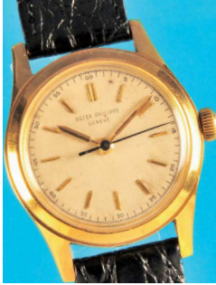
488 Goldarmbanduhr, Patek Philippe Genève, mit Zentralsekunde , verschraubtes Gehäuse, Ref. 2483, versilbertes Zifferblatt mit Stundenindex, Goldzeiger, Zentralsekunde, Ankerwerk cal. 27 SC mit Schraubenunruh und Feinregulierung, Magnetschutzdeckel, intakt (4473), D = 32 mm 4600,-
