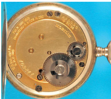
108 Seltene Silbertaschenuhr mit Tourbillon, Mobilis, Nr. 102811 , sogen. Volkstourbillon, guillochiertes Gehäuse vergoldete verzierte Zifferblattfront mit kleinem Emailzifferblatt mit Stunden/Minutenskala mit arabischen Zahlen gebläute Zeiger, im unteren Teil sichtbares, im Uhrzeigersinn rotierendes Drehgestell mit Ankergang (1 Umdrehung in der Minute), vergoldete Brücke, um 1900 intakt (5993), D = 53 mm 2400,-
