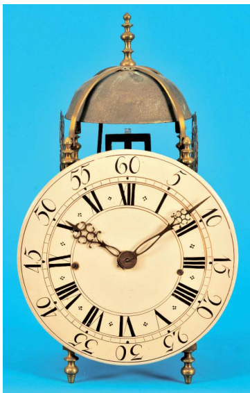
822 Französische Laternuhr mit Fayence-Zifferblatt und Halbstundenschlag auf Glocke , an den Seiten offenes Messingpfeilerwerk, Vayence-Zifferblatt mit römischen Zahlen und großer arabischer Minuterie, ausgeschnittene Messingzeiger, Messingräderwerk mit Ankergang, Gewichts-antrieb über Ketten, 19. Jh., intakt (5910), H = 39 cm 1100,-
