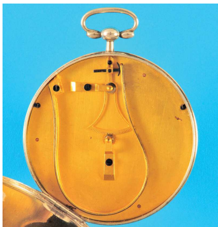
105 Larpen & Jürgensen Kiöbenhavn, seltenes Thermometer in Taschenuhrform , glattes Silbergehäuse, Emailzifferblatt mit Grad-Einteilung, feiner zentraler Zeiger, vergoldetes Werk mit großer u-förmiger Bi-Metall-Feder mit Zahnstange und Rückholfeder, 1.H.19.Jh., intakt (4467), D = 63 mm 2900,-
