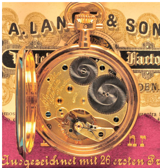
308 Große Goldtaschenuhr im Original-Verkaufs-Etui mit Zertifikat, A. Lange & Söhne Glashütte b./ Dresden, Nr. 63172, glattes 18-carat-Gehäuse mit Sprungdeckel, Außenscharnier, Goldcuvette, Emailzifferblatt mit arabischen Zahlen, kleine Sekunde, vergoldete Zeiger, vergoldetes Werk mit Ankergang, Goldanker und Goldankerrad, Schwanenhals-Feinregulierung, intakt (6137), D = 55 mm, ca. 123g. 3300,-
