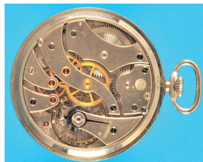
175 Versilberte Taschenuhr, IWC , glattes Gehäuse, versilbertes Zifferblatt mit arabischen Zahlen, kleine Sekunde, gebläute Zeiger, Nickelwerk mit Ankergang, intakt (6396), D = 50 mm 200,-
