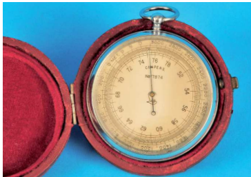
612 Taschenbarometer im Original-Etui , bez. Lufft, Compens. No. 17874, vernickeltes Gehäuse, versilbertes Zifferblatt mit Barometerskala, äußere Drehlunette mit Höhenmeter bis 3000 m, (6014), D = 65 mm 220,-
