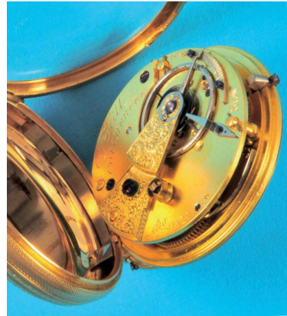
370 Kleine goldene Taschenuhr mit Goldschlüssel im Verkaufs-Etui, 18-carat-Gehäuse, Werkschale mit Blumendekor verziert, Emailzifferblatt mit römischen Zahlen, gebläute Zeiger, vergoldetes Werk über Schnecke und Kette, Spitzzahnankergang, intakt (5860), D = 38 mm 850,-
