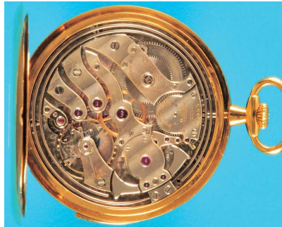
424 Flache Goldtaschenuhr mit Minuten-Repetition, Made for Tiffany by Touchon , glattes 18-carat-Gehäuse, vergoldetes Zifferblatt mit arabischen Zahlen, kleine Sekunde, gebläute Zeiger, Nickelwerk mit Ankergang, Nr. 13955, Schlagabruf auf 2 Tonfedern über seitlichen Schiebe, intakt (6411), D = 47 mm 2400,-
