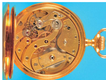
262 Patek Philippe & Co. Genève, Chronometro Gondolo, guillochiertes 18-carat-Gehäuse, Goldcuvette, Emailzifferblatt mit römischen Zahlen, kleine Sekunde, vergoldete Zeiger, vergoldetes Werk mit Ankergang, Kurvenscheiben-Feinregulierung, intakt (6418), D = 56 mm 3900,-
