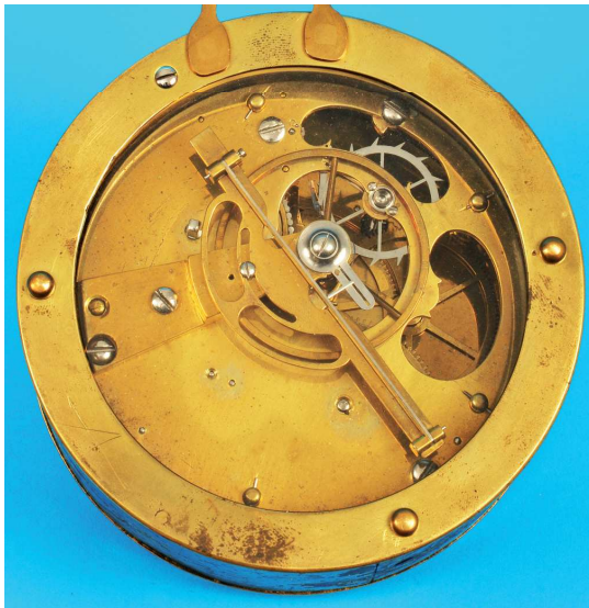
597 Seltenes frühes Experimental-Chronometer mit Temperaturkompensation , sign. John Antes, London (Lit. Baillie S. 7) 1787, rundes Messinggehäuse mit Messingglasunette, Rückseite verglast, weißes Zifferblatt mit 3 Hilfszifferblättern, rechts für Stunden/Minuten mit radial gesetzten römischen Zahlen und arabischer Minuterie, gebläute Pfeilformzeiger, links kleine Sekunde, oben Datumsskala, Messing-Vollplattenwerk mit Schlüsselauzug, polierte Schrauben, Chronometerhemmung mit Feder, dreiarmer Messingunruh und gebläuter Spirale, bimetallische Temperaturkompensationsstreifen, poliertes Stahlchronometerrad mit Diamantdeckstein, Antrieb über Schnecke und Kette, intakt (6062), D = 12 cm 6200,-
