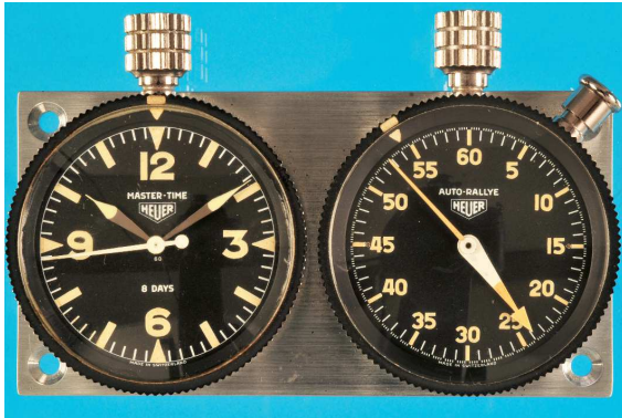
600 Heuer Auto-Rallye-Set, mit Master-Time 8-Tage und Auto-Rallye-Chronograph , auf Metallplatte montierte 8-Tage-Taschenuhr, mit schwarzem Zifferblatt mit arabischen Leuchtzahlen, Leuchtzeiger, Zentralsekunde, Ankerwerk, daneben Chronograph mit seitlichem Drücker und 60-Minuten-Zähler, beide mit Drehlunette, intakt (6503), D = 55 mm 3800,-
