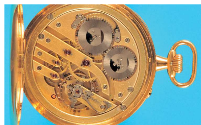
266 Goldtaschenuhr 14-carat-Gehäuse, Emailzifferblatt mit arabischen Zahlen, kleine Sekunde, gebläute Zeiger, vergoldetes Werk mit Ankergang, Schwannenhals-Feinregulierung, 4 geschraubte Chatons, intakt (6428), D = 50 mm 900,-
