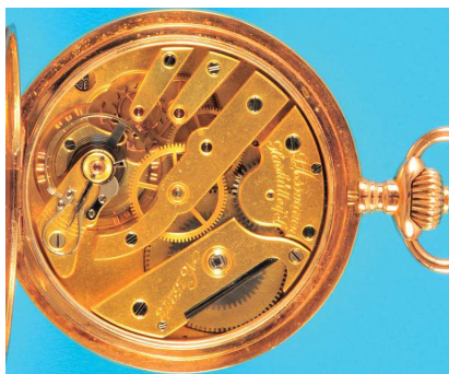
312 Goldtaschenuhr mit Sprungdeckel, J. Assmann Glashütte Nr. 15273, glattes 14-ct.-Gehäuse, Emailzifferblatt mit arabischen Zahlen, kleine Sekunde, vergoldete Zeiger, Ankergang mit Goldausgleichsanker und Ankerrad, intakt (5776), D = 52 mm 2300,-
