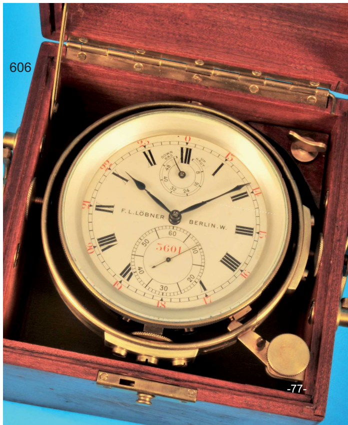
606 Marine-Chronometer Ulysse Nardin, Nr. 3601, auf Blatt sign. F.L.Löbner, Berlin.W., im 2-tlg. Holzgehäuse mit Traggriffen, kardanisch gelagertes Gehäuse, versilbertes Zifferblatt mit römischen Zahlen, kleine Sekunde, Skala für 56- Stunden-Gangreserve bei der "12", gebläute Zeiger, Werk mit Schnecke, Kette und Gegengesperr, Chronometerhemmung mit Feder, Kompensationsunruh mit Ausgleichsgewichten, freischwingende, zylindrische Spirale, Diamantdeckstein, intakt (6442), M = 18,5 x 18,5 x 18,5 cm 1800,-
