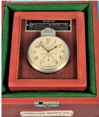
589 Bord-Chronometer mit Gangreserve-Anzeige im Holzkästchen, mit Transport-Übergehäuse , auf Zifferblatt sign. Hamilton Watch Co., Lancaster, PA, U.S.A. , verschraubtes Gehäuse bez. Bureau of Ships, U.S.Navy, N8106, 1943, Chronometer Watch, versilbertes Zifferblatt mit arabischen Zahlen, gebläute Zeiger, kleine Sekunde bei der „6“, Gangreserve-Anzeige bei der „12“, Nickel-Brückenwerk mit Streifenfedor, Hamilton Watch Co., Modell 22 , 21 Jewels, 6 Adjustierungen, Ankerwerk mit Kompensationsunruh, Feinregulierung mittels Exzenterscheibe, intakt (6439), D = 70 mm, M (Transport-Übergehäuse) = 21 x 17,5 x 9,5 cm 1100,-
