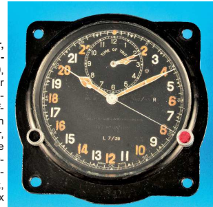
592 Englische Borduhr, S.Smith & Sons, London , Ref. No. 6A/839, L7/39, mit zentraler Chronographensekunde und 24-Stunden-Zifferblatt mit arabischen Zahlen, Leuchtzeiger, kleine Skala für „Time Trip“ bei der „24“ mit 60-Minuten- und 12-Stunden-Zähler, Ankerwerk, intakt (6358), M = 9,5 x 9,5 cm 170,-
