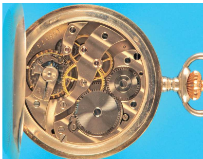
170 Silberne Taschenuhr mit Sprungdeckel, Paul Moser Nr. 195504, glattes Gehäuse, Emailzifferblatt mit römischen Zahlen, kleine Sekunde, gebläute Zeiger, Nickel-Brückenwerk mit Ankergang, intakt (6398), D = 53 mm 220,-
