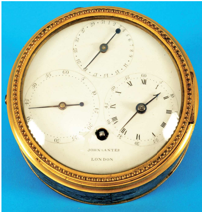
597 Seltenes frühes Experimental-Chronometer mit Temperaturkompensation , sign. John Antes, London (Lit. Baillie S. 7) 1787, rundes Messinggehäuse mit Messingglasunette, Rückseite verglast, weißes Zifferblatt mit 3 Hilfszifferblättern, rechts für Stunden/Minuten mit radial gesetzten römischen Zahlen und arabischer Minuterie, gebläute Pfeilformzeiger, links kleine Sekunde, oben Datumsskala, Messing-Vollplattenwerk mit Schlüsselauzug, polierte Schrauben, Chronometerhemmung mit Feder, dreiarmer Messingunruh und gebläuter Spirale, bimetallische Temperaturkompensationsstreifen, poliertes Stahlchronometerrad mit Diamantdeckstein, Antrieb über Schnecke und Kette, intakt (6062), D = 12 cm 6200,-
