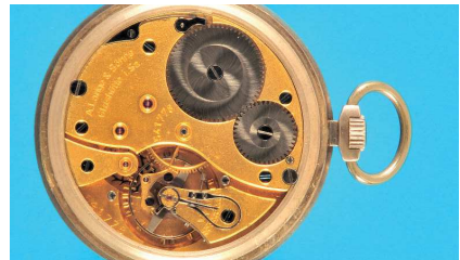
305 Silbertaschenuhr, A.Lange & Söhne Glashütte i.Sachsen, Nr. 541778, glattes Gehäuse, Emailzifferblatt mit arabischen Zahlen, kleine Sekunde, vergoldete Zeiger, vergoldete 3/4-Platinenwerk mit Ankergang, Stahlanker und Stahlankerrad, Schwanenhals-Feinregulierung, intakt (5430), D = 50 mm 700,-
