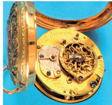
529 Gold-Email-Spindelstaschenuhr , Werkschale mit Diamantrosen und Emailportrait eines Mädchens verziert, Außenscharnier, vordere Seite ist mit Diamantrosen umlaufend verziert, Emailzifferblatt mit römischen Zahlen, vergoldete Zeiger, vergoldetes Vollplatinenwerk mit Spindelgang über Schnecke und Kette, filigrane Spindelbrücke, intakt (6661), D = 38 mm 2700,-
