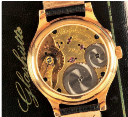
501 1A-Taschenuhrwrk Adolph Lange, Dresden, Nr. 7947 später in ein 18-carat-Armbanduhrgehäuse eingebaut, im neuen Glashütter Verkaufs-Etui, beidseitig verglastes Gehäuse, Emailzifferblatt mit römischen Zahlen, kleine Sekunde, gebläute Zeiger, ¾-Platinenwerk mit Ankergang, Goldanker und Goldankerrad, 4 geschraubte Chatons, Diamantdeckstein, intakt (6143), D = 40 mm 3500,-
