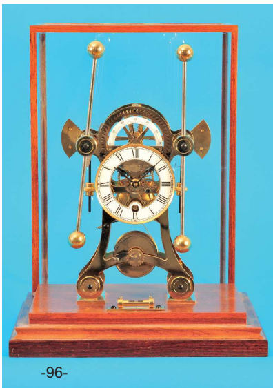
766 Dekorative, skelettierte Tischuhr mit gegenläufigen Pendeln und seltener Grashopper-Hemmung nach John Harrison von 1735 (Nachbau), 20.Jh., die Uhr verdeutlicht die Grundidee, wie 2 gegenläufige Pendel Fehler durch Bewegungen wie auf See ausgleichen sollen, rundum verglastes Holzgehäuse, polierter, skelettiertes Werk, weißer Ziffering mit römischen Zahlen, im oberen Teil Sekundenskala, mit umlaufendem Ankerrad, mit 2 gegenläufigen Pendeln, 8-Tage-Werk mit Antrieb über Schnecke und Drahtseil, intakt (5242), M = 47 x 34 x 25 cm 1750,-
