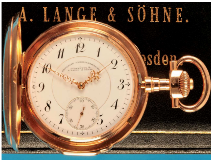
307 Große Goldtaschenuhr im Original-Verkaufs-Etui, Deutsche Uhrenfabrikation Glashütte i./Sa, A. Lange & Söhne, Nr. 37479, glattes 14-carat-Gehäuse mit Außenscharnier, Goldcuvette, Emailzifferblatt mit arabischen Zahlen kleine Sekunde, vergoldete Zeiger, vergoldetes ¼-Platinwerk unter Glasschutz, mit Ankergang, Goldanker und Goldankerrad,, Schwanenhals-Feinregulierung, intakt (6139), D = 57 mm , ca. 138 gr. 3300,-
