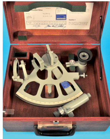
625 Trommel-Sextant im Holzkasten , Freiberger Präzisionsmechanik GmbH, 1992, Modell „Sirius“ , mit Gebrauchsanleitung, Ausführung mit Fernrohr 4 x 40 und Augenschutzmuschel (6063), M = 32,5 x 28 x 16 cm 550,-
