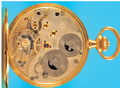
245 Goldsavonette, IWC , 18-ct.-Gehäuse mit Sprungdeckel, Emailzifferblatt mit arabischen Zahlen, kleine Sekunde, Ankerwerk mit Schwannenhals-Feinregulierung, intakt (5772), D = 45 mm 1300,-
